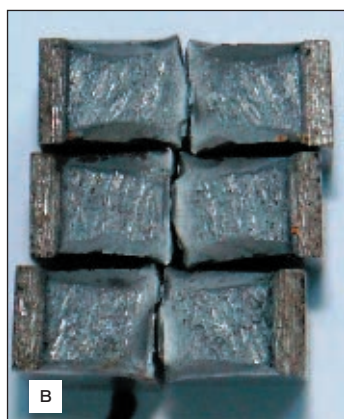
Рис. 7. Образцы после испытаний на изгиб (а) и ударную вязкость при температуре 20°С (б) и 40°С (в)
