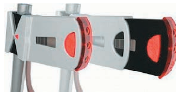
Аккумуляторный отсек в задней части рамы велосипеда. Справа — с выдвинутым аккумулятором
