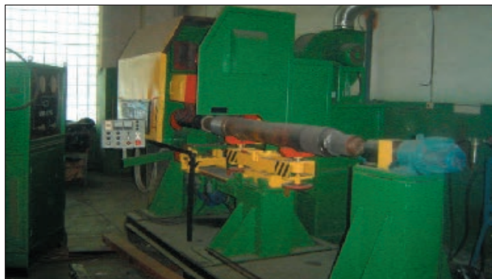
Рис. 2. Общий вид установки КТ–088 для восстановления шейки и подступичной части оси колесной пары методом плазменно-дуговой металлизации
