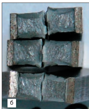
Рис. 7. Образцы после испытаний на изгиб (а) и ударную вязкость при температуре 20°С (б) и 40°С (в)
