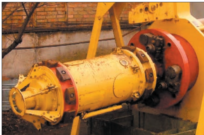
Рис. 1. Устройство для подготовки кромок непосредственно перед сваркой
