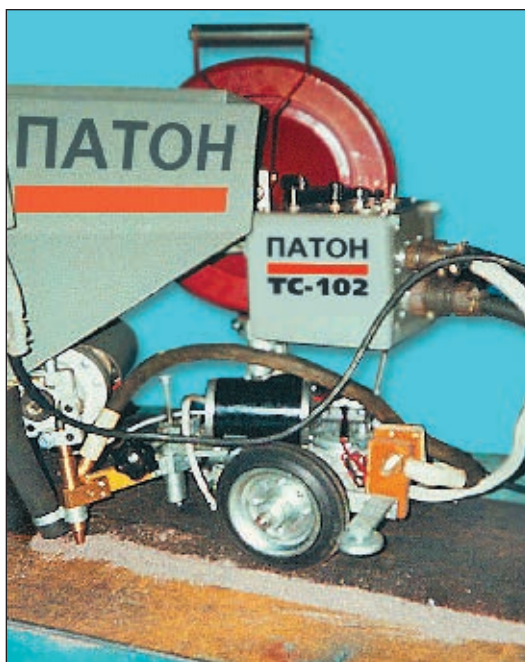
Рис. 3. Сварка стыкового шва «вне базы»
