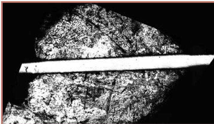
Рис. 3. Адгезионное соединение проволоки из нержавеющей стали 1X18H9T с расплавленным металлом медного многожильного провода; ×150
