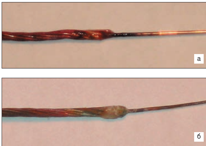
Рис. 4. Сварно-паянное соединение медного провода с проволокой из нихрома (а), из нержавеющей стали (б)
