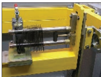
Рис. 5. Приспособление для сборки труб конвектора с термостатом
