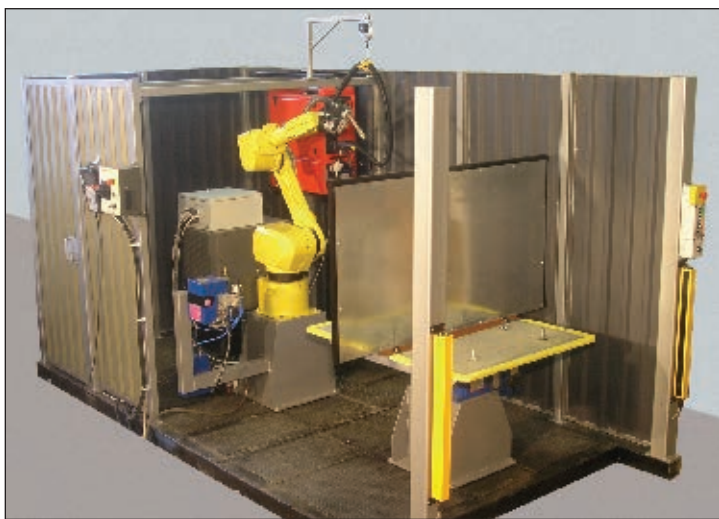
Рис. 2. Робототехнологический комплекс РК752 (снята передняя панель ограждения комплекса) для сварки каркаса тормозной колодки
