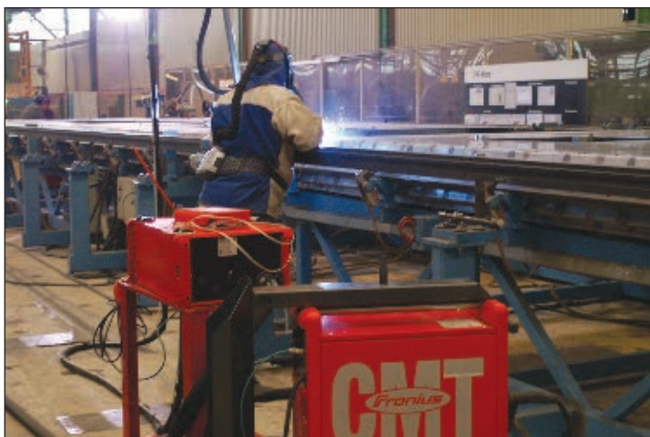
Рис. 1. Сварка соединения длиной 18 м боковины вагона с падугой
