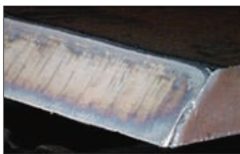
Резка толстолистовой углеродистой стали под углом 45° при использовании ацетилена (слева) и пропана (справа)
