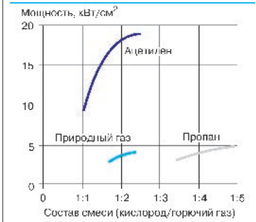
Мощность первичного пламени различных горючих газов в зависимости от состава горючей смеси
