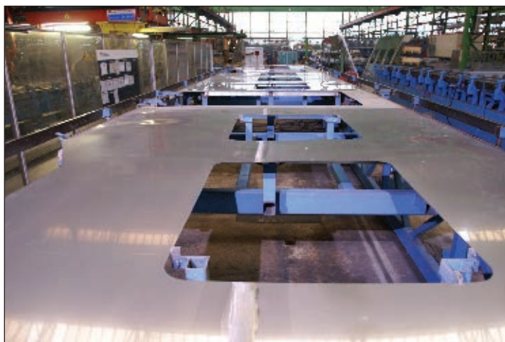
Рис. 3. Согласно техническим требованиям на крупных боковинах не должно быть сварочных деформаций и брызг
