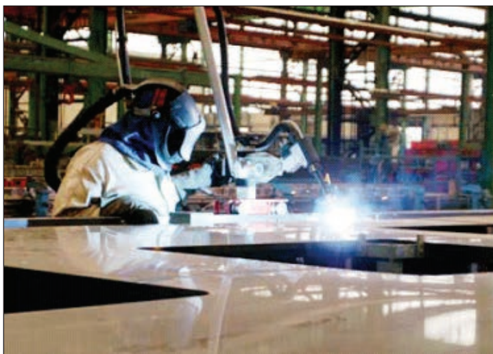
Рис. 2. Каретка перемещает верхнюю часть сварочной горелки вдоль участка соединения
