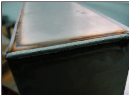
Пример № 2. Сварка электрошкафа (Kuka и Fronius СМТ)
