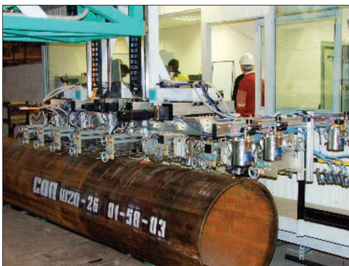
Рис. 5. Установка для автоматического ультразвукового контроля продольных сварных соединений труб
