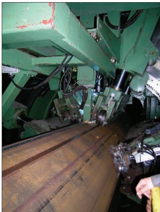
Рис. 2. Сборка трубной заготовки и сварка технологического шва в защитном газе
