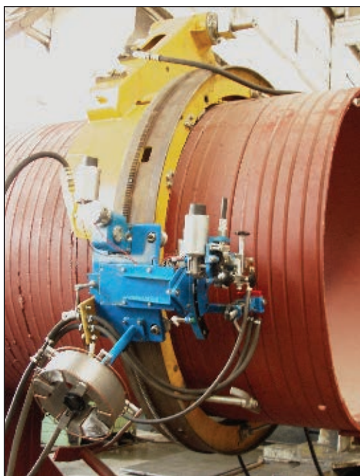
Рис. 7. Сварочный аппарат комплекса «Стык» для автоматизированной электродуговой сварки порошковой проволокой с принудительным формированием шва неповоротных стыков труб диаметром 1420 мм (изготовлен ОАО «Каховский завод электросварочного оборудования»)
