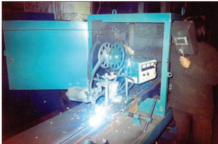
Рис. 3. Автоматизированная сварка балки
