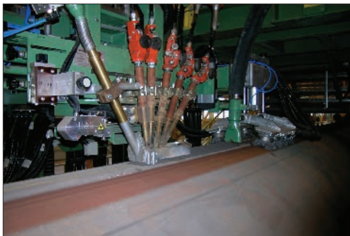
Рис. 4. Пятидуговая сварка под флюсом наружного шва
