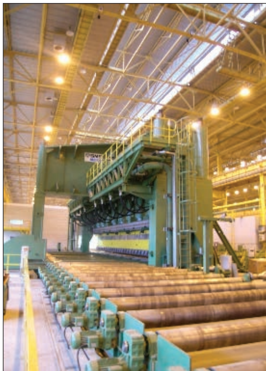
Рис. 1. Пресс для «шаговой» формовки трубных заготовок диаметром 530–1420 мм с толщиной стенки до 50 мм
