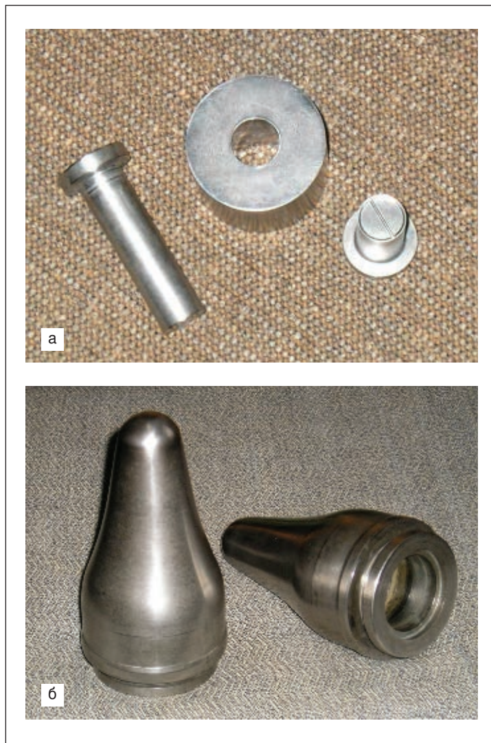
Рис. 2. Детали, упрочненные карбидохромовым покрытием в расплаве солей: а — детали пресс-формы (сталь ХВГ), б — плунжеры для производства стеклотары (сталь 8ХФ)
