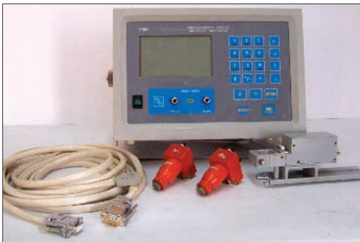
Рис. 1. Общий вид ультразвукового прибора контроля напряжений
