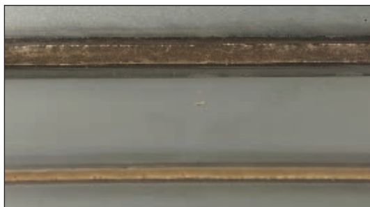
Рис. 9. Пайка СМТ оцинкованных листов толщиной 1 мм. Скорость пайки 1,1 м/мин
