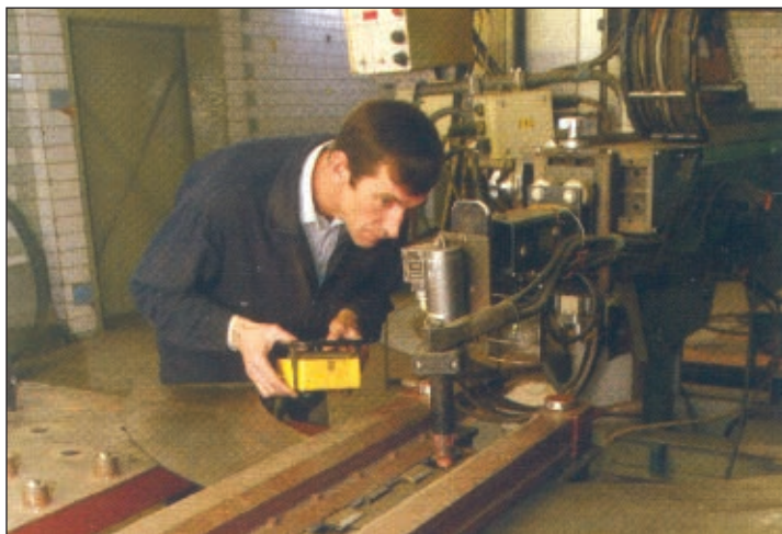
Рис. 2. Сварка одной из автоматических сварочных TIG-станций
