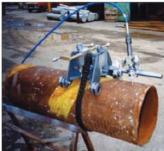
Рис. 4. Переносная машина для гидро- абразивной резки труб и подготовки кромки ОАО «Энимс» (Москва)
