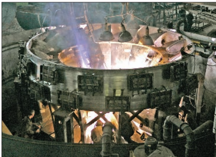
Рис. 2. Сварка рабочего колеса гидротурбины для ГЭС «Тэри» (Индия)
