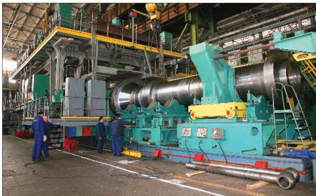
Рис. 3. Изготовление вала гидротурбины по экспортному заказу
