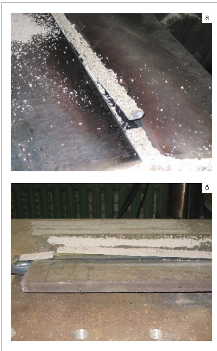
Рис. 1. Швы, выполненные в V-образную (а) и X-образную (б) разделки свариваемых кромок
