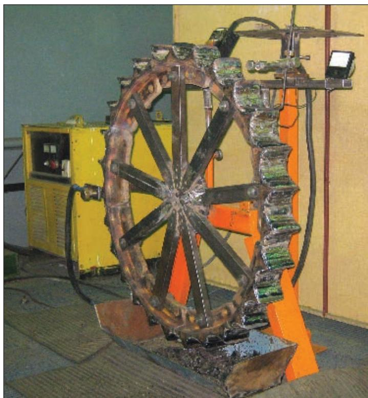
продолжительность подготовительных работ и зависимость состава наплавленного металла от режима наплавки. Количество вводимого порошка оказывает существенное влияние на эффективность наплавки. Относительная доля порошка, расплавляемого вместе с электродом, оценивается коэффициентом  $\beta$ , который представляет собой отношение расплавленного присадочного  $G_{\Pi}$  и электродного металла  $G_{Э}$ :  $\beta = G_{\Pi} : G_{Э}$ .
