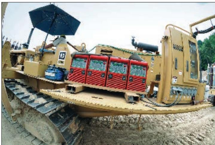
Применение процесса СМТ вместо сварки покрытыми электродами в этом случае обеспечивает большие преимущества.
