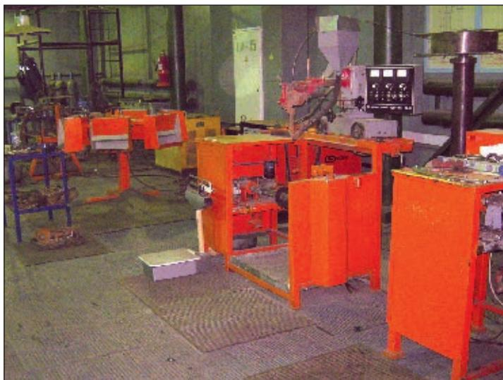
Рис. 7. Наплавочные установки в цехе восстановления деталей гусеничного хода ООО «Севертрансэкскавация» (Усинск)
