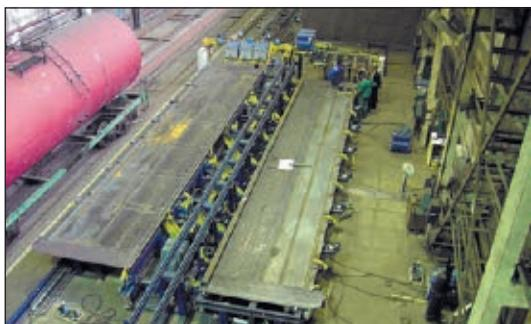
Рис. 2. Линия автоматической сварки боковых стен полувагонов
