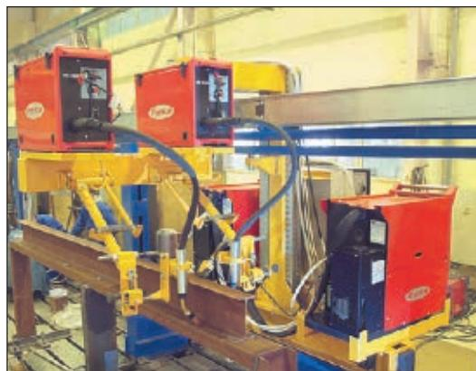
Рис. 4. Стенд автоматической сварки хребтовой балки с двутавром
