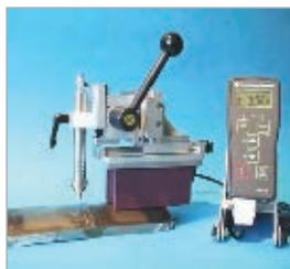
MIC 10 измеряет твердость в HV и переводит табличным способом в значения шкал HB, HRC, HRB и предела прочности на разрыв в Н/мм<sup>2</sup>.
