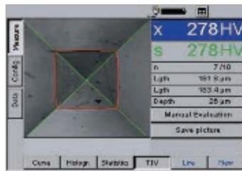
При плохом качестве подготовки поверхности рекомендуется использовать оптический твердомер TIV. Это позволит получить реальное значение твердости даже при попадании пирамидки на пустоты или при неправильном угле приложения усилия. Твердомер TIV измеряет твердость материала по Виккерсу с возможностью получения видимого изображения отпечатка при использовании индентора — алмазной пирамидки.
