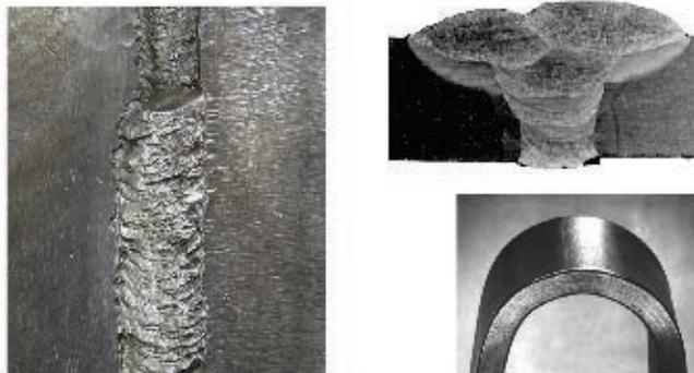
Внешний вид сварного шва, выполненного порошковой проволокой ППС-АН2, и испытания соединения на изгиб
