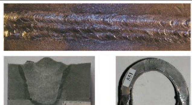
Внешний вид сварного шва, выполненного электродами ЭПС-АН1, и испытания соединения на изгиб
