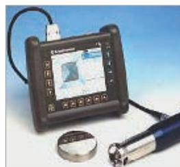
Как только нагрузка при испытании достигает определенного значения, вдавливание автоматически оценивается и преобразуется без использования измерительного микроскопа. В дополнение к автоматической оценке можно также оценить углубление вручную. После визуальной оценки грани углубления можно корректировать вручную на увеличенном изображении на дисплее. Длина диагоналей автоматически преобразуется в соответствующее значение твердости.
