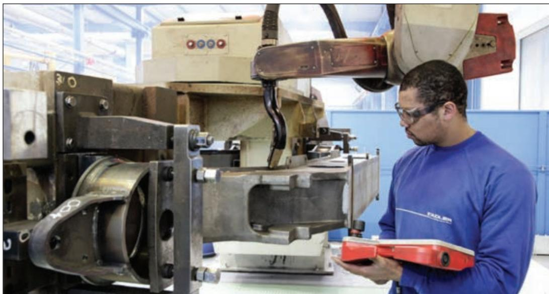
Благодаря сварочному роботу с системой TimeTwin Digital удалось повысить производительность сварки стыков тележек для железнодорожных вагонов более чем на 100%
