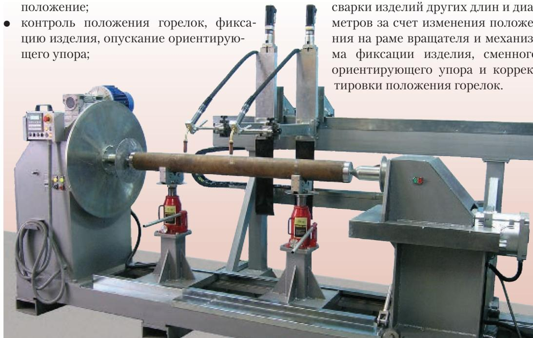
Рис. 3. Установка для сварки кольцевых швов корпуса шаровых кранов DN 400-600
