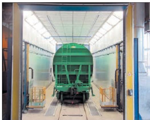
Рис. 6. Покрасочно-сушильная камера
