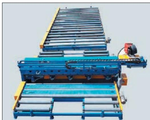
Рис. 5. Стенд автоматической сварки полотнищ боковой и торцевой стенок вагона-хоппера
