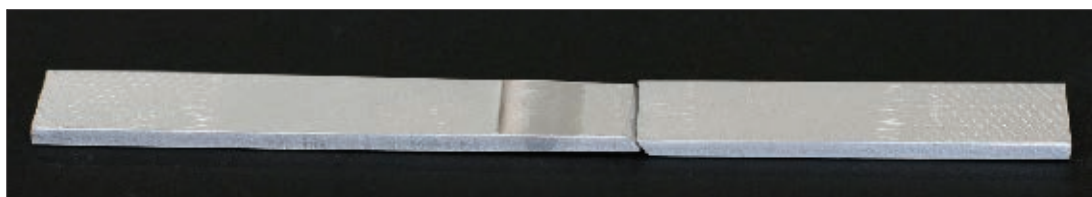
Рис. 7. Область разрушения стыковых сварных соединений из сплава 1561 толщиной 3 мм
