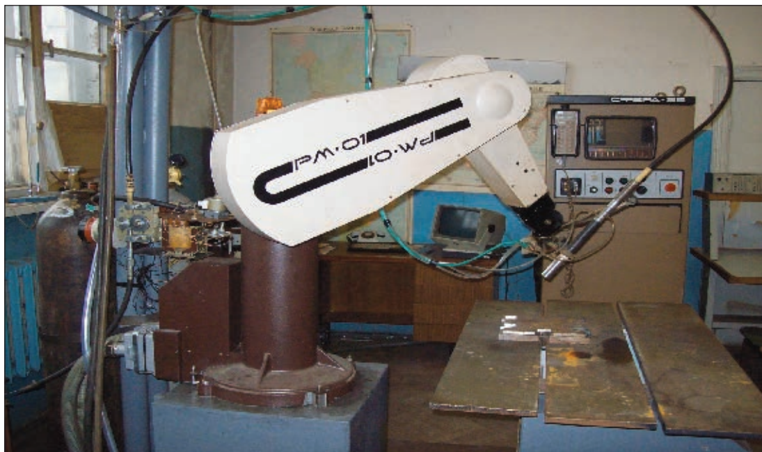
Рис. 2. Опытный образец РТК для наплавки штампового инструмента
