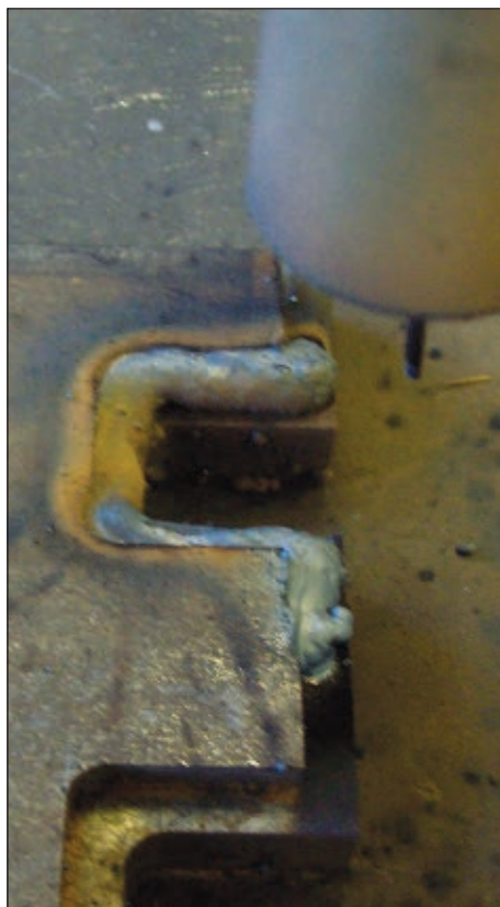
Рис. 4. Вид наплавленного валика при эксперименте № 3
