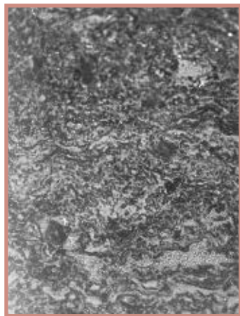
Рис. 3. Микроструктура износостойкого покрытия из порошковой проволоки (x450)
