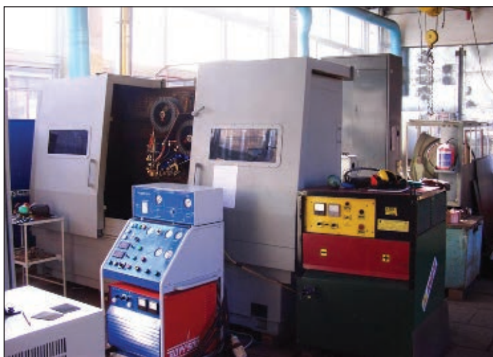
Рис. 6. Напылительный комплекс в составе установки Plazer15-SA и полуавтомата 15ВБ для напыления
