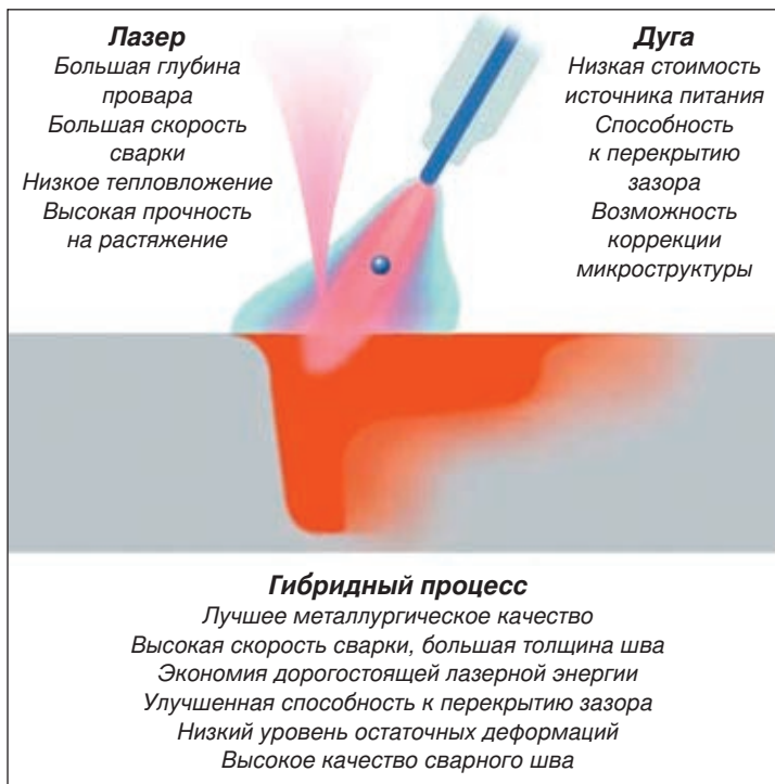
Рис. 2. Сочетание процессов лазерной и дуговой сварки
