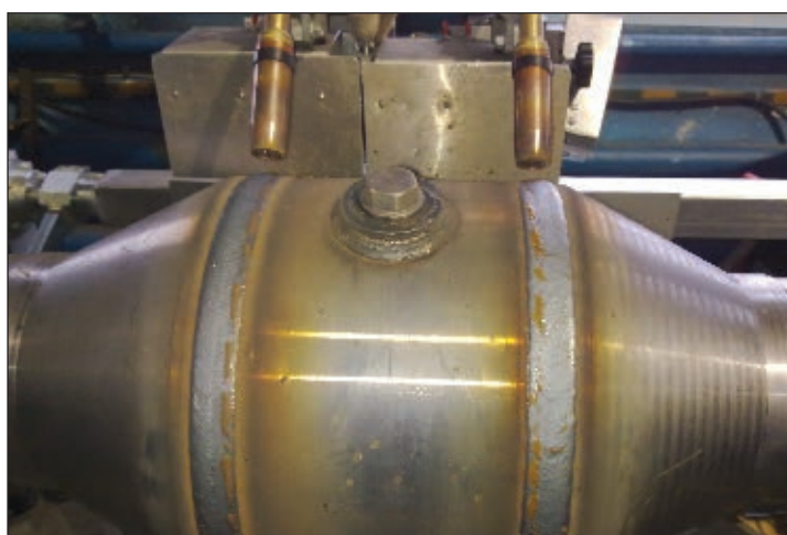
Рис. 4. Сваренный корпус (облицовочные швы сварены с колебаниями горелки)
