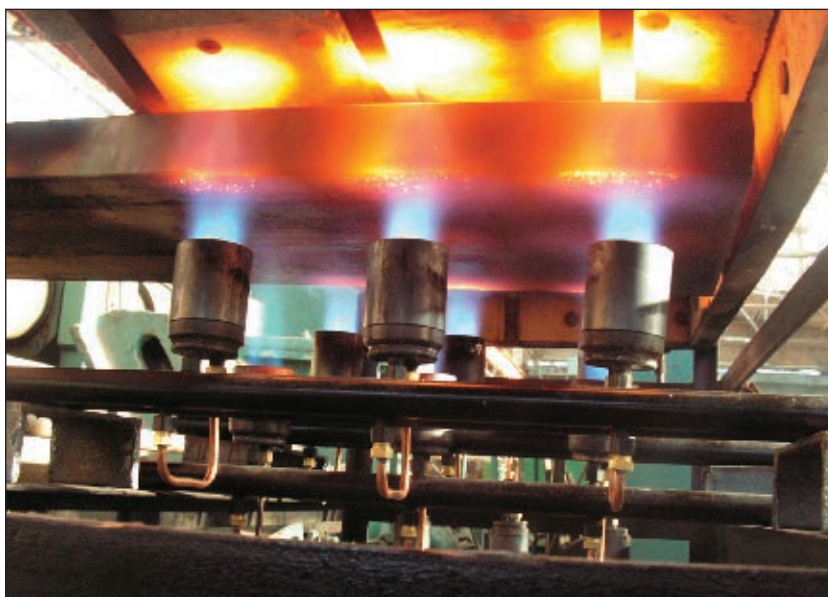
Рис. 9. Нагрев концов листа толщиной 70 мм до температуры 650 °C в процессе их вальцевания при изготовлении обечаяк
