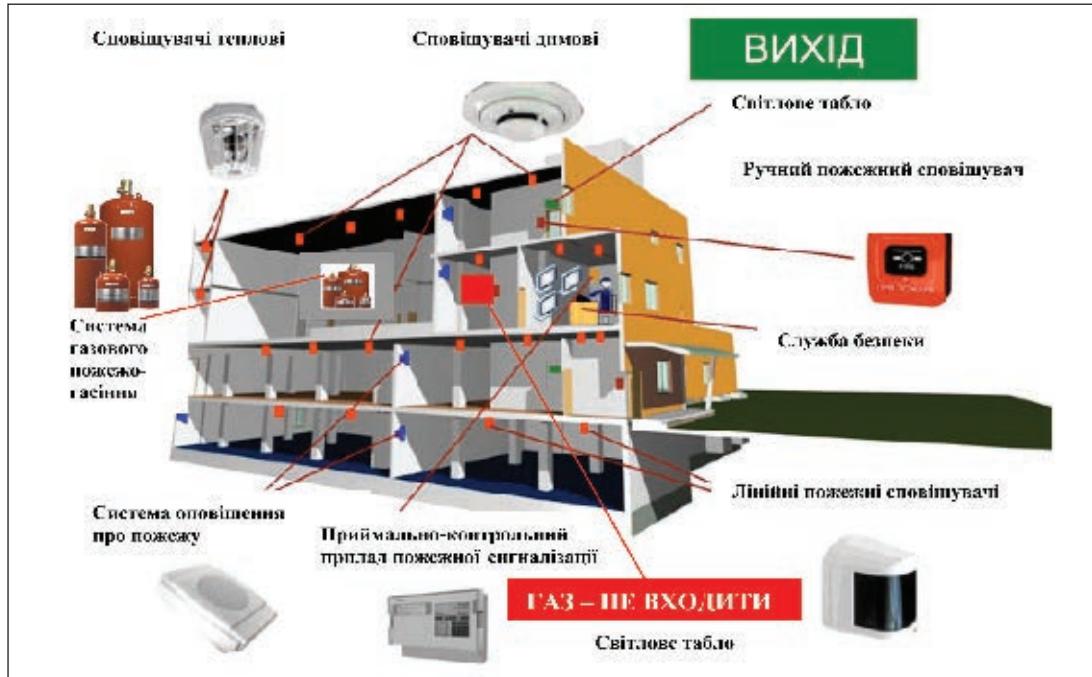
Рис. 1. Приклад використання систем пожежної сигналізації, автоматичного пожежо-гасіння та оповіщення
