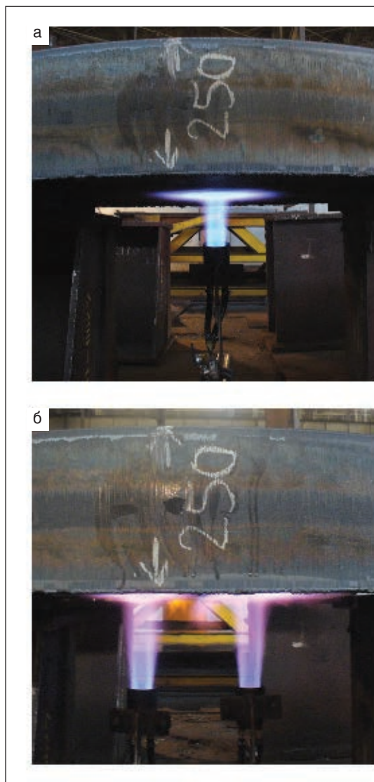
Рис. 5. Нагрев заготовки массой 3051 кг одной (а), двумя (б) и тремя (в) горелками ГВ-ВК7
