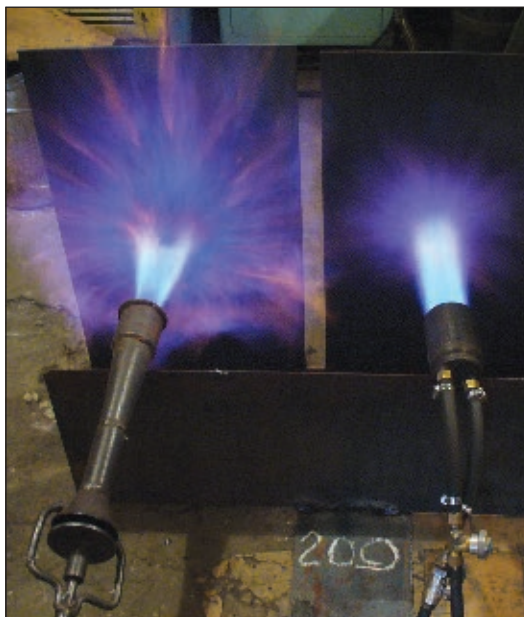
Рис. 1. Одновременный нагрев листа 4×400×600 горелкой ОГК-3 (слева) и ГВ-ВК7 (справа). Расстояние между листом и горелками 100, 200, 300 мм; время нагрева до появления светящегося пятна 4 мин
