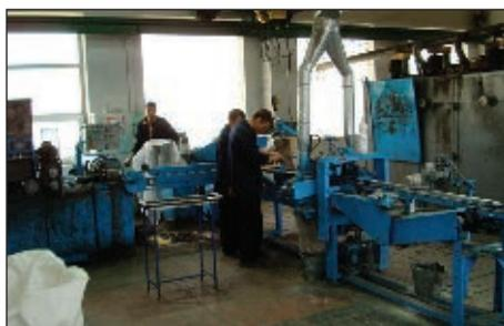
Рис. 1. Линия изготовления электродов на прессе ПЭО1000
