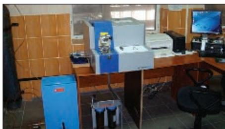
Рис. 2. Рентгеноспектрометр «Spectromax»
