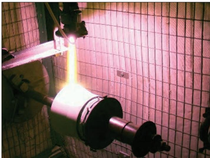
Рис. 2. Напыление термобарьерного покрытия на деталь реактора пиролиза
