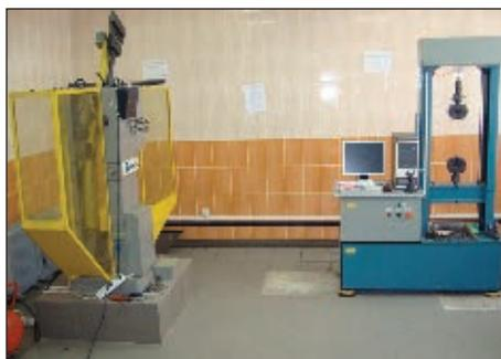
Рис. 3. Разрывная машина Р5М и маятниковый копер 2010 КМ-30
