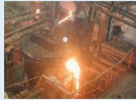
Благодаря тесному сотрудничеству с ИЭС им. Е. О. Патона завод освоил производство сварочных флюсов **двойным рафинированием расплава**. Этот наиболее прогрессивный способ варки флюсов, защищенный патентами, существенно улучшил сварочно-технологические свойства флюсов при сохранении благоприятного соотношения качества и цены.
