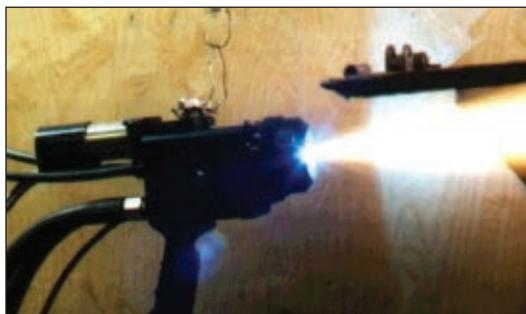
Рис. 3. Напыление стали АДМ-аппаратом
