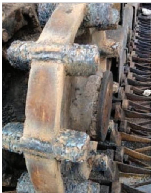
Рис. 1. Внешний вид восстановленной ведущей звездочки крана КС8165
