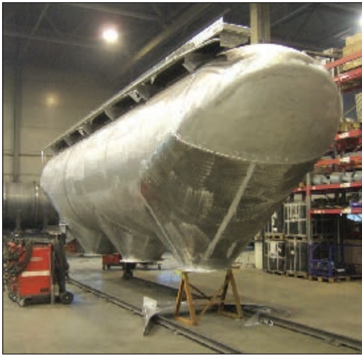
Рис. 6. Корпус цементовоза с фрагментом воронки, изготовленной с помощью сварки трением с перемешиванием
