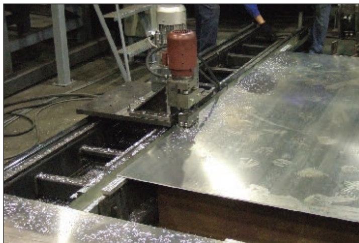
Рис. 3. Установка для фрезерования кромки листов
