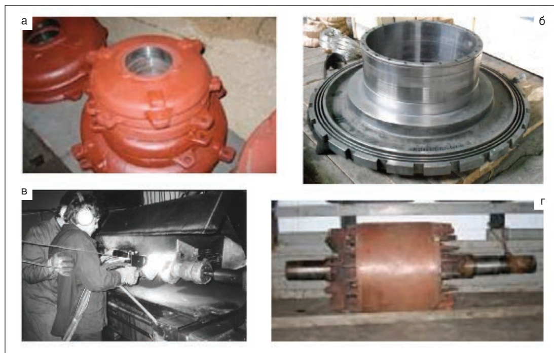
Рис. 3. Детали с покрытиями со структурой МСА: а — подшипниковые щиты электродвигателей диаметром 250–1200 мм («ТехНаМет», Магнитогорск); б — опора станка, на поверхности скольжения диаметром 500 мм покрытие толщиной 5 мм (Машпром, Екатеринбург); в — коленчатый вал двигателя «Камаза» (Авторемзавод, Красноярск); г — ротор электродвигателя, шейки под подшипники качения («ПермьГлобалстройсервис»)
