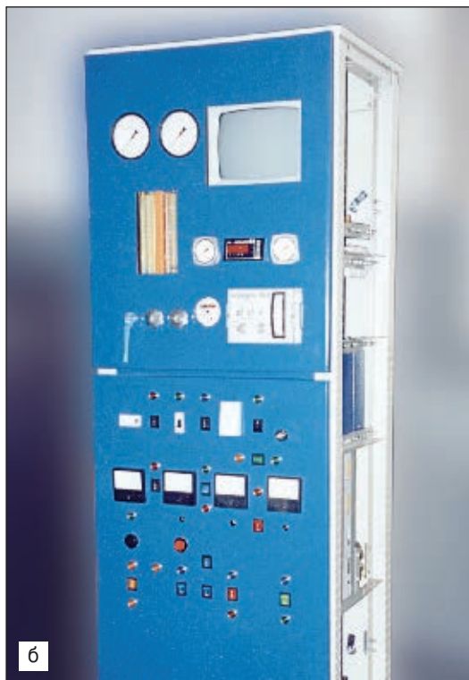
Рис. 4. Внешний вид шкафов управления полуавтоматом PLAZER ISS-75-PL (а) и плазменной установкой PLAZER 75-PL (б)
