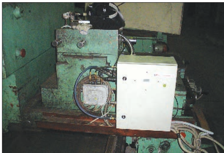
Рис. 2. Блок поджига и сканирования дуги, смонтированный на суппорте станка
