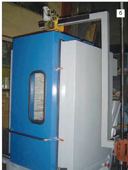
Рис. 3. Внешний вид полуавтоматов для напыления (а) и абразивоструйной подготовки (б) гильз судовых и локомотивных двигателей
