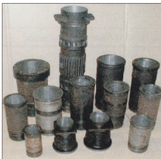
Рис. 6. Цилиндрические втулки тяжелонагруженных дизелей с плазменным покрытием
