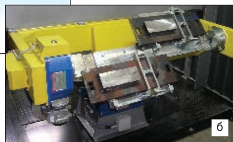
Рис. 2. Приспособления для сварки изделия типа «подкладка с упором» (а) и «подкладка с подушкой» (б)
