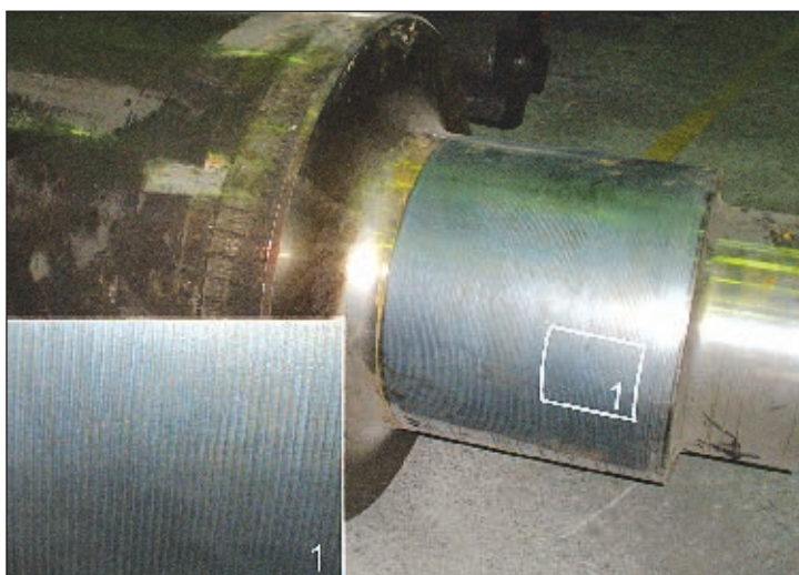
Рис. 5. Шейка прокатного валка после ЭДЗ
