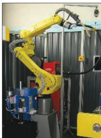
Рис. 3. Промышленный робот фирмы FANUC Robotics, устройство очистки и смазки горелки Binzel, комплект сварочного оборудования Fronius
