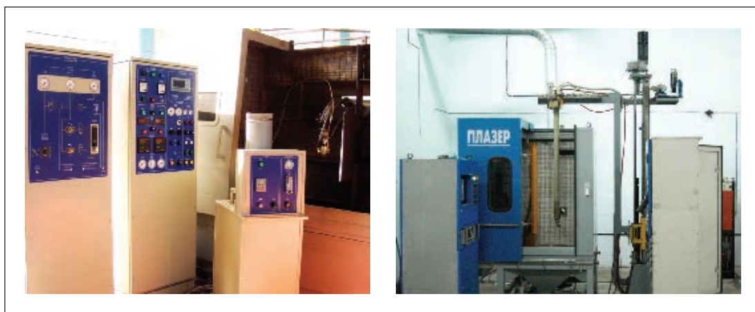
Рис. 1. Примеры комплектов оборудования PLAZER® для плазменного порошкового напыления покрытий
