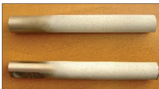
Рис. 4. Внешний вид деталей с керамическим плазменным покрытием ZrO 2 -7%Y 2 O 3 , нанесенным по технологии PLAZER®
