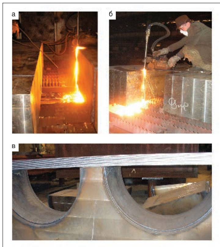
Рис. 8. Вырезка отверстий диаметром 800 мм резакom TORH-M на заготовках корпуса подшипника толщиной 450 мм, сталь 40X: а — врезание; б — окончание резки; в — поверхность реза. Мундштук №4, диаметр режущего канала 4,5 мм
