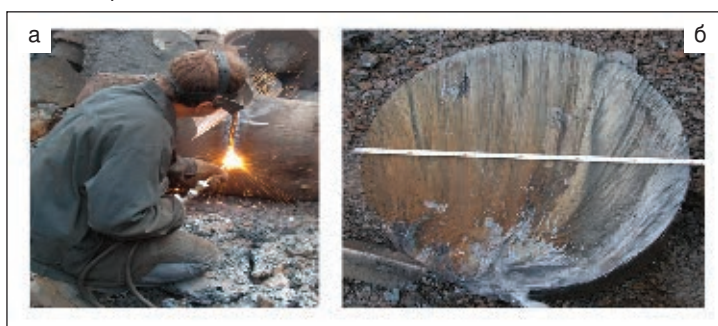
Рис. 5. Резка лома (а), поверхность реза (б). Поковка диаметром 600 мм из стали 18Х2Н2, группа лома Б13. Резак ТОРН-Р. Мундштук №5, диаметр канала режущего кислорода 5 мм. Давление кислорода в сети 0,9 МПа
