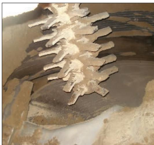
Рис. 1. Лопасть центрального узла вращения смесителя WM2-70
