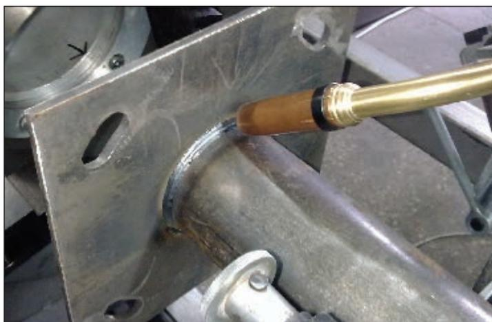
Рис. 2. Кольцевой шов соединения трубы с фланцем
