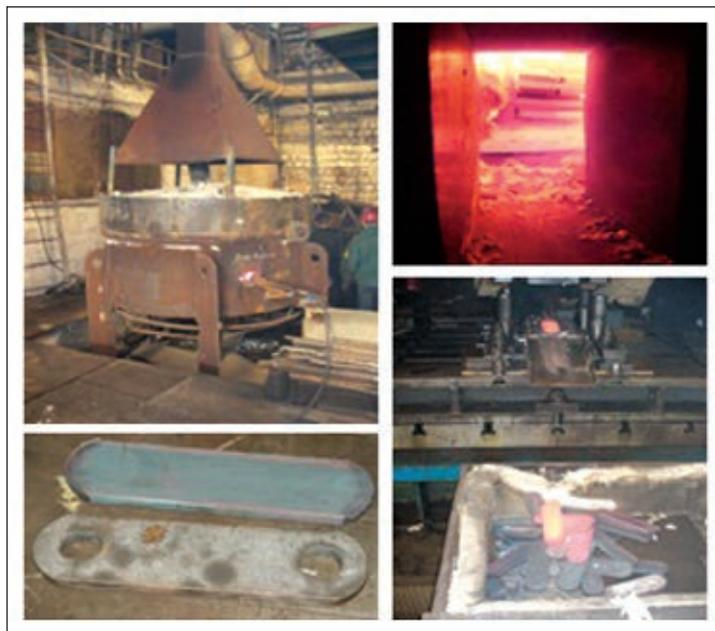
Рис. 1. Нагрев и штамповка звеньев цепи из листовых заготовок толщиной 16 мм
