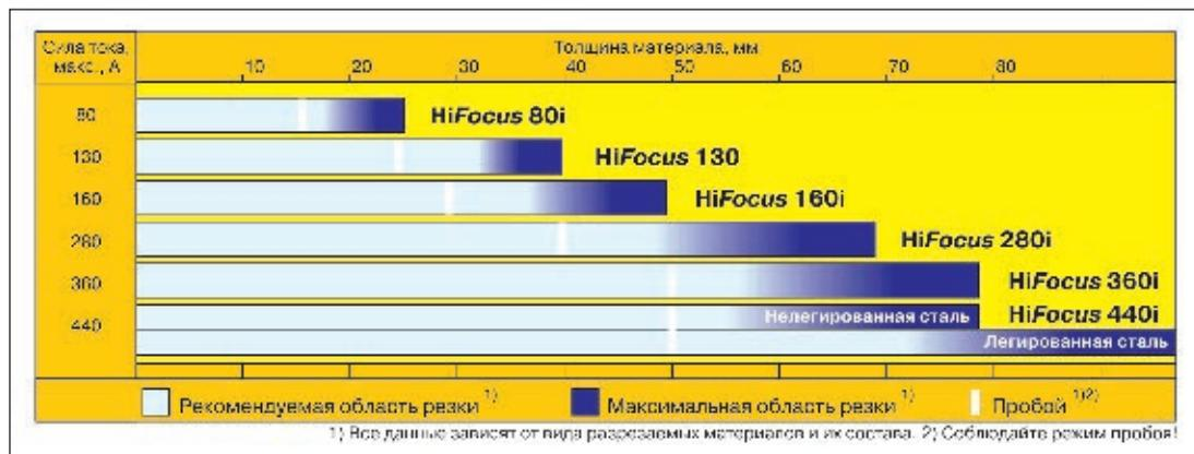
Рис. 3. Области применения различных установок плазменной резки Hi-Focus
