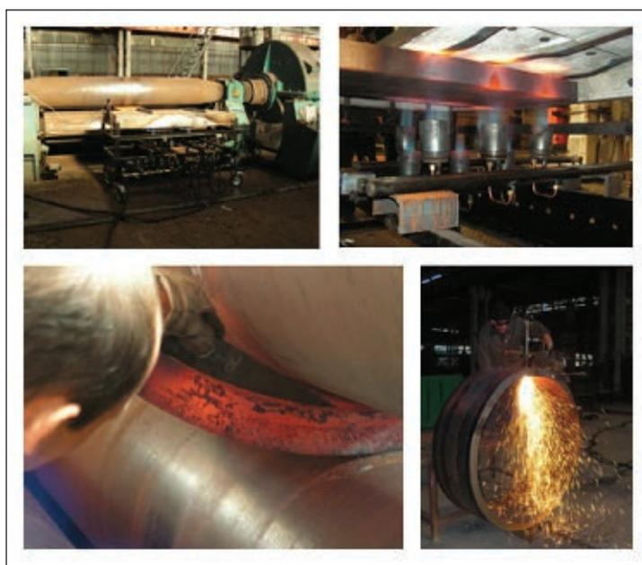
Работа установки на заводе показала ее эффективность. Конец листа сечением 70×700 мм прогревается на глубину 600 мм до температуры 650°С за 32 мин при использовании трех коллекторов с тремя горелками ГВ-ВК7 на каждом. Общий расход природного газа в расчете на один нагрев составил 28 м<sup>3</sup>. При отсутствии на заводе печного оборудования необходимой мощности без данной установки процесс нагрева концов листа для подвальцовки невозможен.
