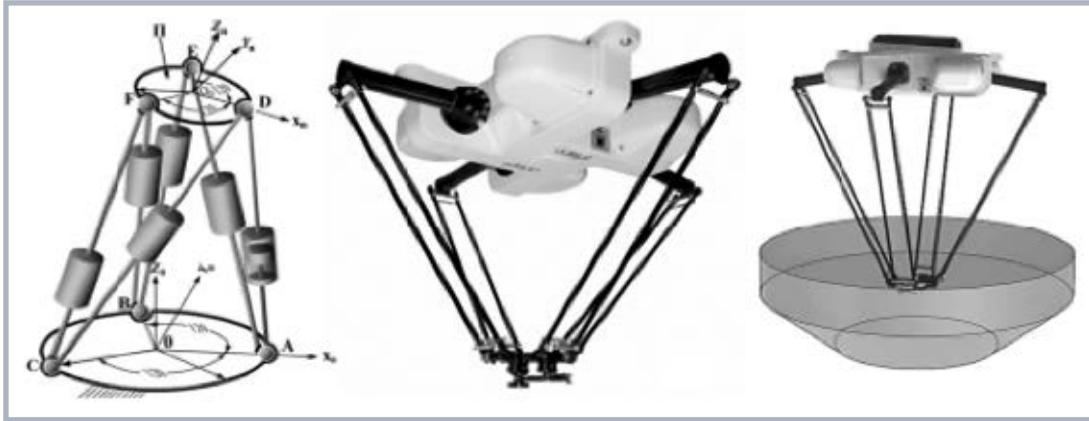
Рис. 6. Параллельный робот
