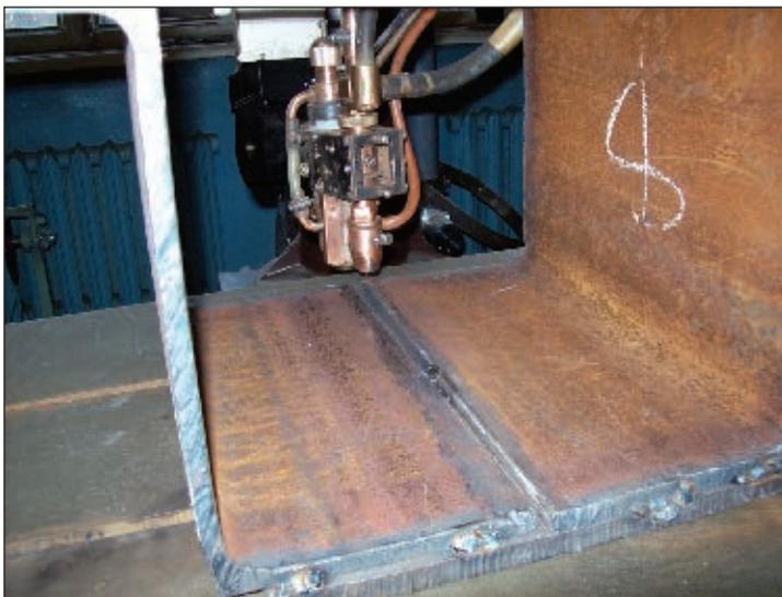
Рис. 4. Зетобразный профиль, сваренный с помощью комбинированного процесса
