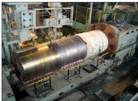
Рис. 5. Предварительный и сопутствующий нагрев плунжера массой 55 т при его наплавке
