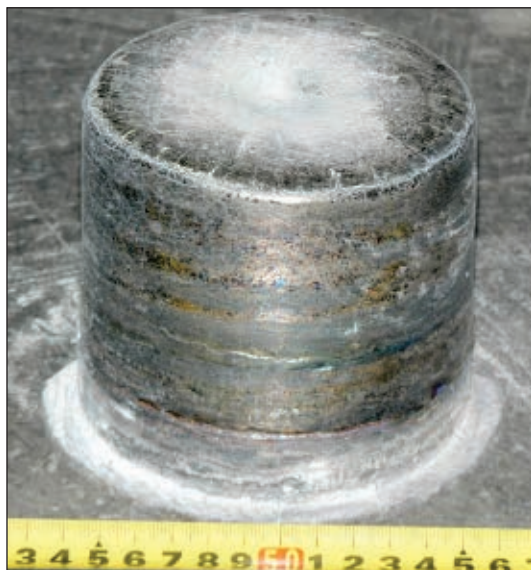
Рис. 5. Внешний вид слитка титана, полученного переплавом в камерной электрошлаковой печи электрода из компактированной стружки
