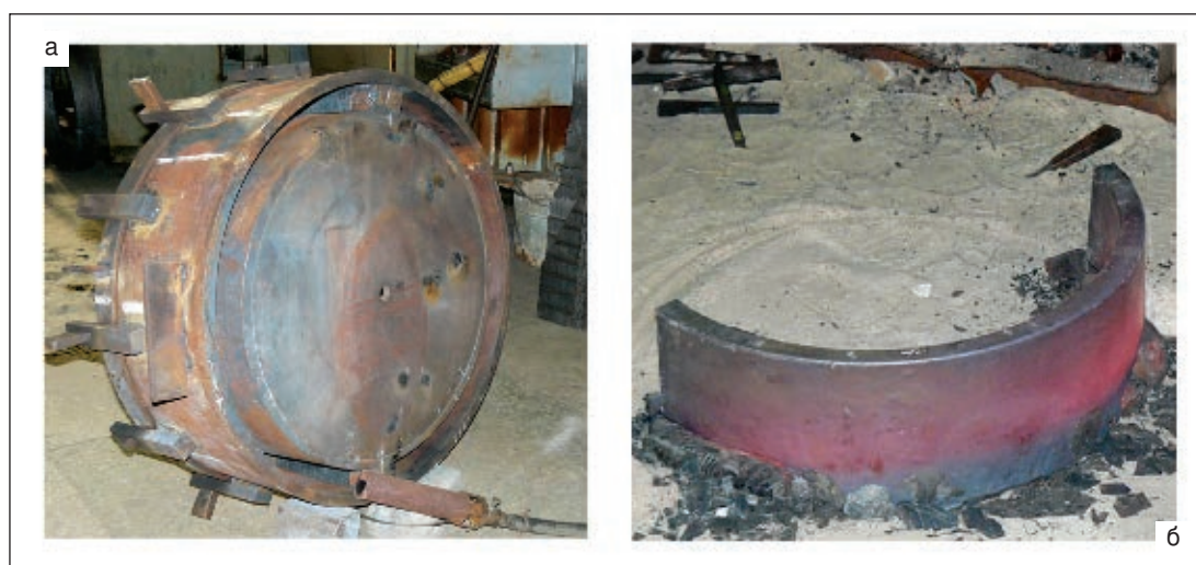
Рис. 4. Кольца, изготовленные с помощью электрошлакового кокильного литья: а — отлитая заготовка с кристаллизатором в сборе; б — отлитое полукольцо
