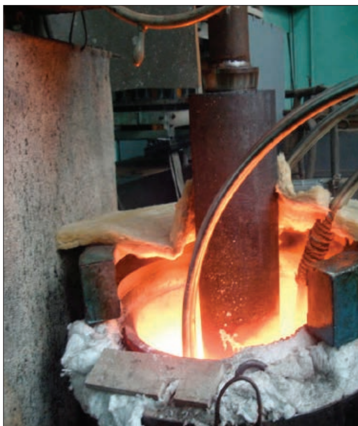
Рис. 6. Изготовление подового электрода способом электрошлаковой наплавки меди на сталь
