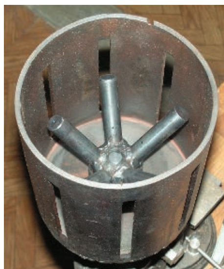
Рис. 2. Внешний вид (а) и конструкция (б) газовой горелки ГВ-ВО для мемориальных комплексов
