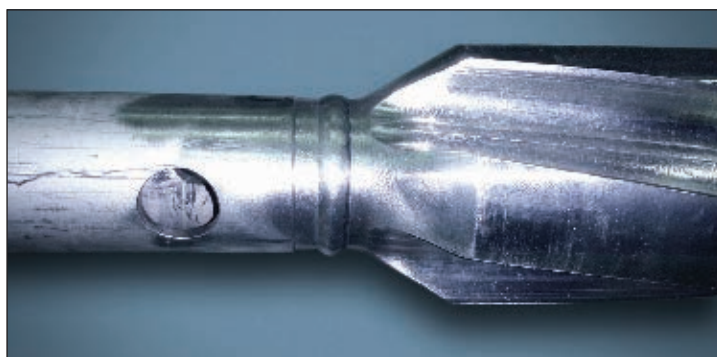
Рис. 3. Внешний вид сварного шва
