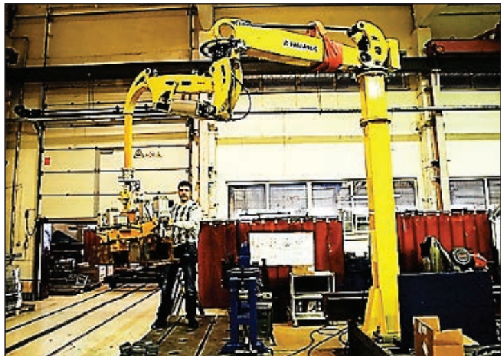
Рис. 5. Манипулятор Famatec для закрепления и перемещения комплекта упоров
