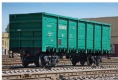
Рис. 2. Универсальный полувагон модели 19-12-9853 с разгрузочными люками с нагрузкой от оси колесной пары на рельсы 25 т
