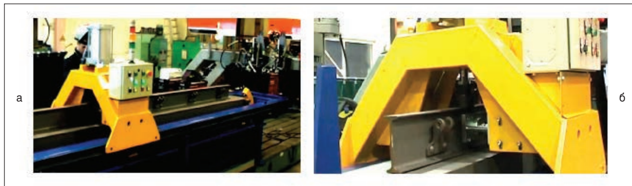
Рис. 8. Общий вид сборочной тележки (а) со смонтированными на ней вертикальным и боковым пневмоприжимами (б)
