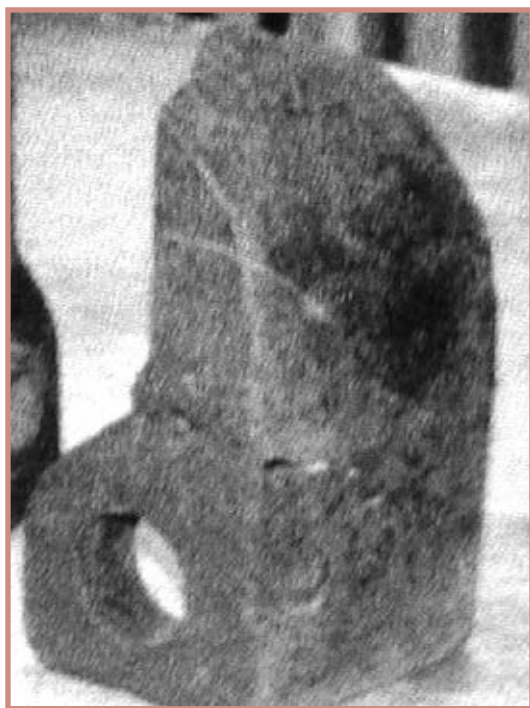
Рис. 1. Общий вид изношенной П-образной билы
