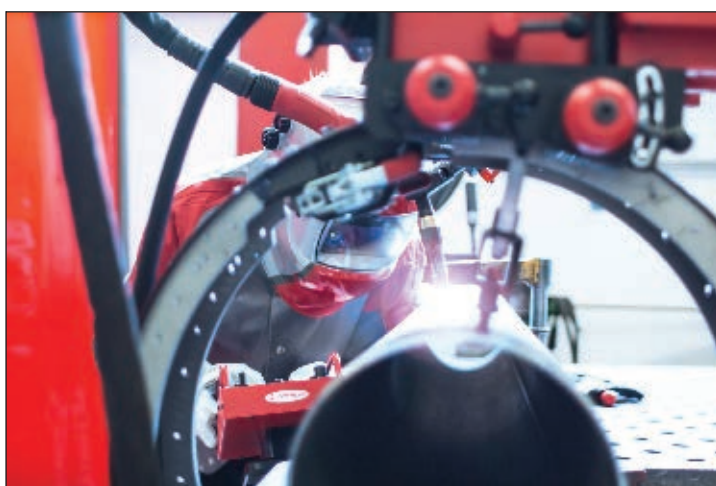
Сегменты направляющих различной длины обеспечивают широкий диапазон диаметров свариваемых труб
