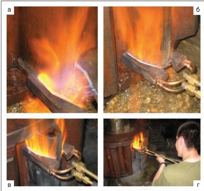
атируются горелки для закалки поверхностей направляющих механообрабатывающих станков, валков и роликов любых размеров, шеек валков, ходовых колес, ручьев блоков и многих других деталей. На рис. 5 и 6 показаны некоторые из этих горелок.
