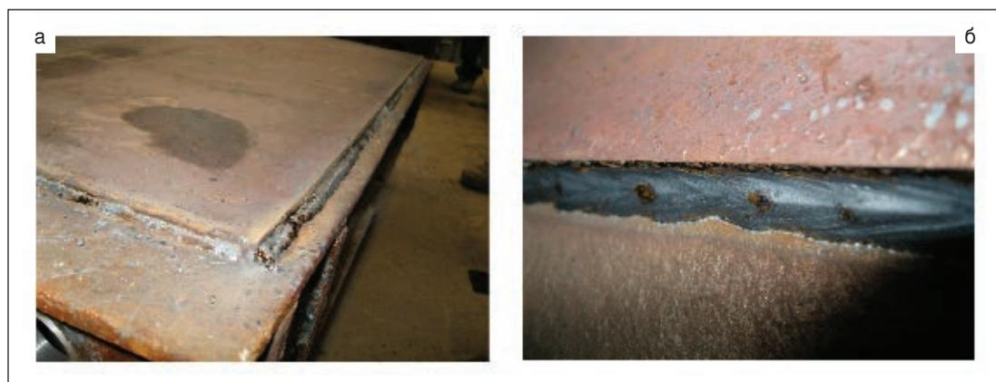
Рис. 6. Эксперимент по сварке в сварочной смеси CORGON18, проведенный в ПАО «Дружковский машиностроительный завод»: а — сварка в среде  $\text{CO}_2$ , сталь Ст3, толщина 10 мм, проволока СВ08Г2С, 1,6 мм, скорость подачи 9,0 м/мин, расход газа 12 л/мин; б — сварка в среде CORGON18, сталь Ст3, толщина 10 мм, проволока СВ08Г2С, 1,6 мм, скорость подачи 9,0 м/мин, расход газа 12 л/мин. Достигнута экономия сварочной проволоки 17,19%
