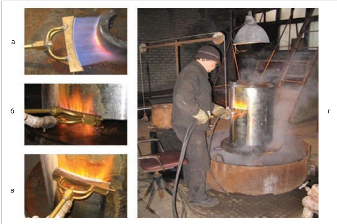
Рис. 7. Участок для поверхностной закалки роликов: а — факел горелки ГЗУ-6-600 для закалки ролика диаметром 600 мм, горящий в свободном пространстве; б — начало закалки ролика; в — процесс закалки этого ролика; г — участок для закалки тел вращения
