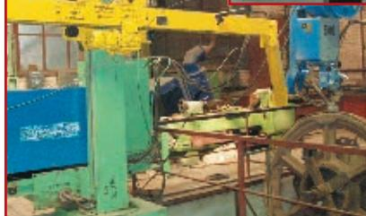
**PM-15** — универсальная установка автоматической дуговой наплавки деталей горного оборудования
