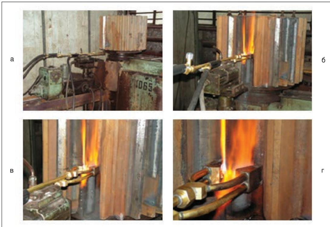
Рис. 8. Машинная закалка зубьев шестерни с модулем 25
