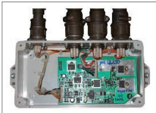
Рис. 6. Блок управления электродвигателем постоянного тока (крышка снята)
