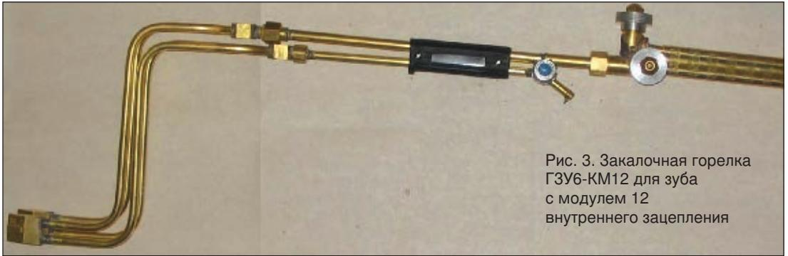
Рис. 3. Закалочная горелка ГЗУ6-КМ12 для зуба с модулем 12 внутреннего зацепления
