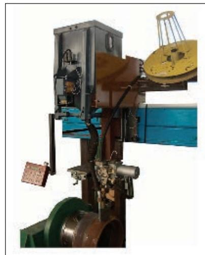
Рис. 11. Установка КТС 3-5 для наплавки крановых колес под флюсом
