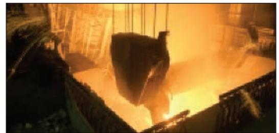
вые перевозка слитка, температура которого составляет 500°C, из сталеплавильного цеха в кузнечно-прессовый осуществлена автотранспортом. Для этого потребовалось разработать и изготовить специальный термос и использовать специальную технику.
