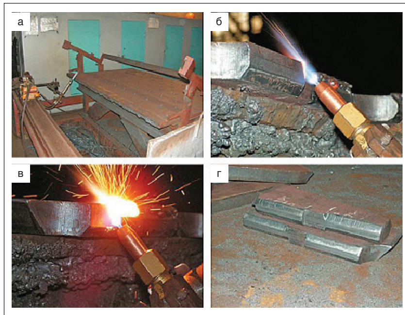
Рис. 7. Двусторонняя подготовка кромок под сварку листа толщиной 40 мм с помощью резака РГКМ-1-SR на переносной машине «Радуга» (а–в), поверхность реза (г)
