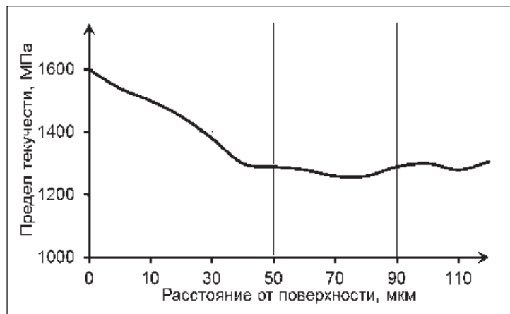
Рис. 5. Изменение предела текучести ( \sigma_{0,2} ) по глубине обработанного слоя стали Р6М5 после ИПО
