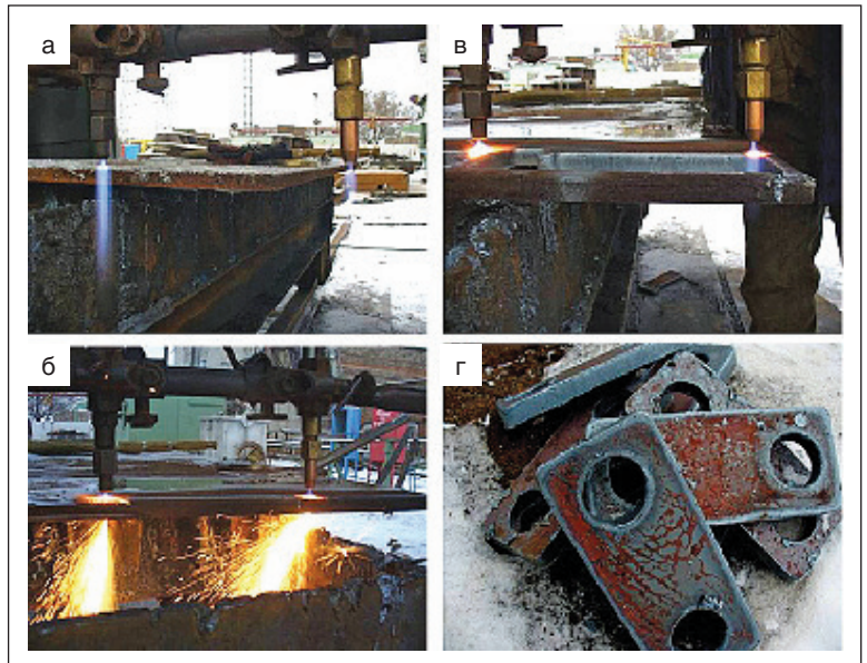
Рис. 5. Одновременная вырезка деталей из листа толщиной 16 мм. Резак РМ-2 установлен на штанге машины АСШ-70 слева, резак РГКМ-1-SR — справа: а — факелы сравниваемых резаков; б — врезание; в — резка; г — вырезанные детали
