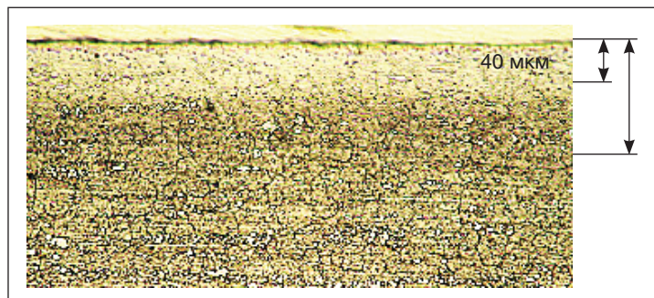
Рис. 3. Структура поверхностного слоя стали Р6М5 после импульсно-плазменной обработки, х500
