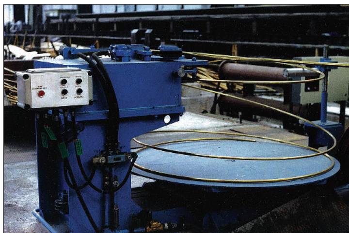
Рис. 4. Свертка трубной заготовки в бухту и обрезка ее конца
