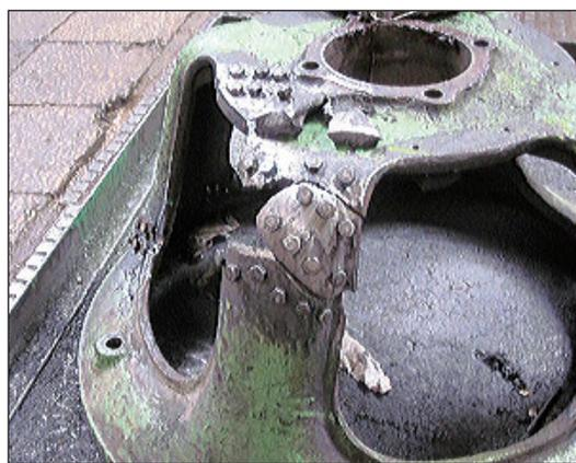
Рис. 11. Кожух электродвигателя строгательного станка, подготовленный к восстановительным работам
