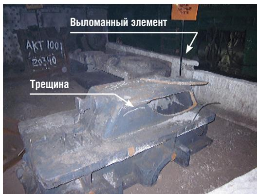
Рис. 8. Внешний вид изломанной крышки редуктора
