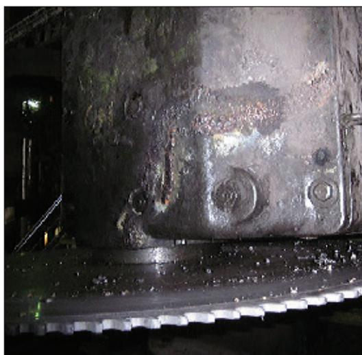
Рис. 10. Восстановленная крышка разрушенной пилы
