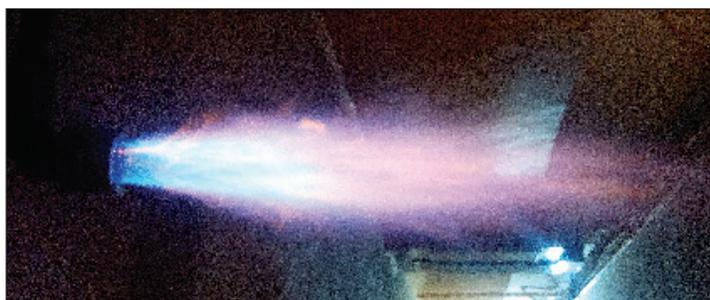
Рис. 2. Испытание горелки ГН 53/3,9 М на открытом пространстве
