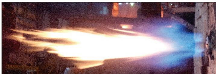
Рис. 5. Работа модернизированной горелки ГНД-100 М
