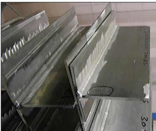
Рис. 3. Сварочная система TPS/i произвела большое впечатление на экспертов компании SLOB B.V. Оксидную пленку с алюминиевой поверхности больше не нужно удалять
