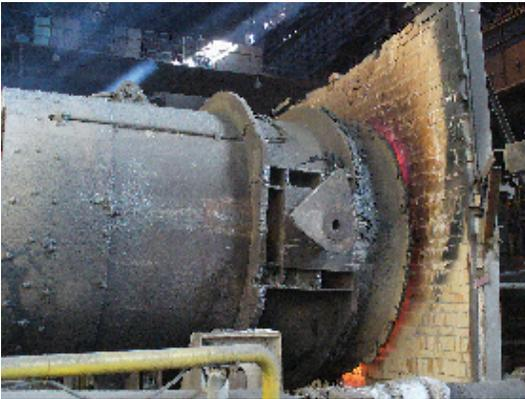
Рис. 6. Горизонтальный стенд для 90-тонных сталеразливочных ковшей шибберного типа в процессе разогрева горелкой ГНД-100 М
