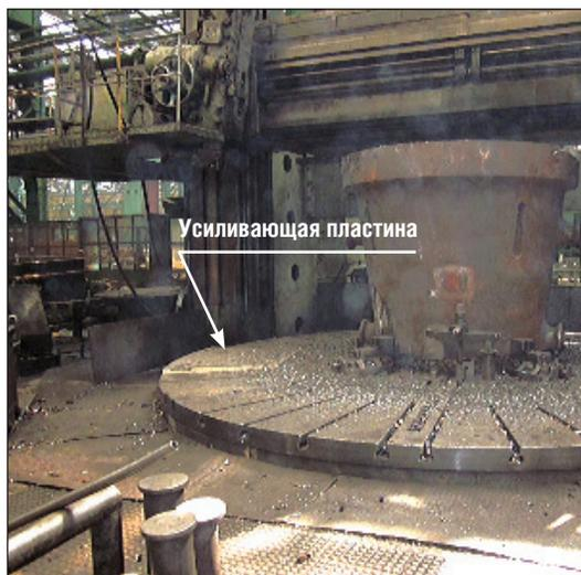
Рис. 12. Вид восстановленной планшайбы карусельного станка
