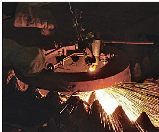
Рис. 2. Резка полуавтоматом «Смена-2М» внутренних радиусных фасок
