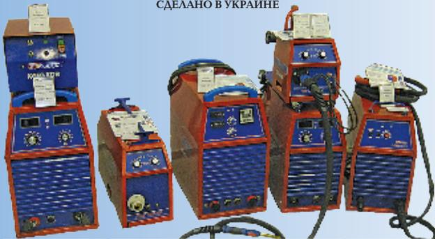
ИНВЕРТОРНЫЕ ИСТОЧНИКИ ТОКА НА БАЗЕ IGBT-ТРАНЗИСТОРОВ
