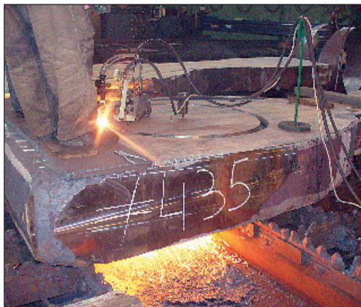
Рис. 5. Резка заготовки «Крышка подшипника» толщиной 450 мм
