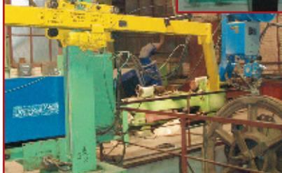
РМ-15 — универсальная установка автоматической дуговой наплавки деталей горного оборудования
