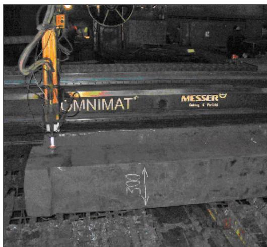
щиной до 45 мм при врезке с кромки листа, а при пробивке — до 40 мм (рис. 4).
