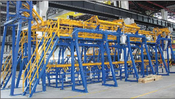
Рис. 10. Универсальный стэнд сборки изотермического кузова
