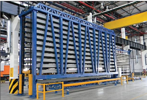
Рис. 11. Механизированный склад для складирования профильного проката.
