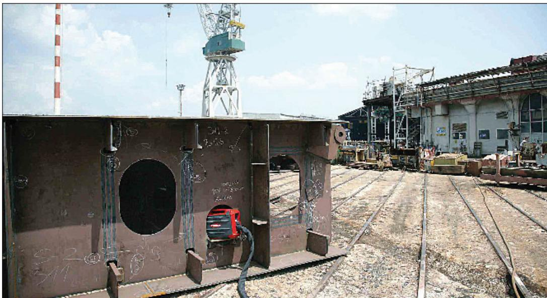
Модель VR 5000 Case с катушками D200, как и другие механизмы подачи проволоки серии Case с катушками малого размера, имеют массу менее 10 кг и проходят в любые люки.
