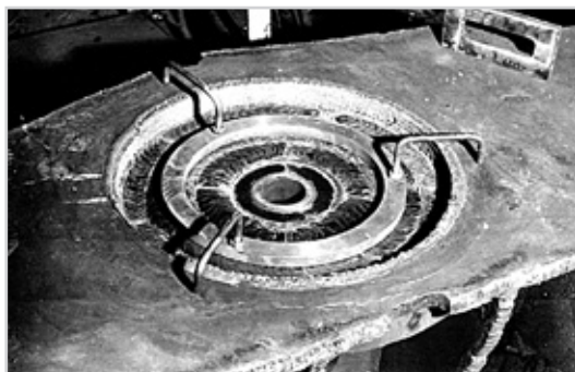
Рис. 1. Поверхность подпятника восьмиосной 120 т цистерны, наплавленной электродами АНП-13
