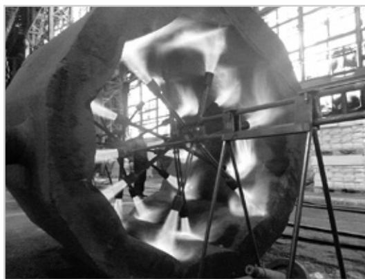
Рис. 7. Стенд для нагрева изложниц пятой группы слитков
