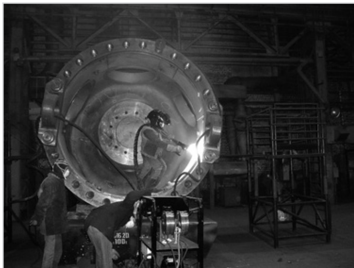
Рис. 4. Электродуговое напыление алюминием корпуса рабочего колеса поворотно-лопастной гидротурбины
