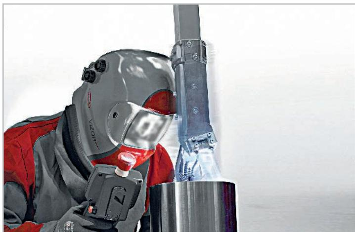
Рис. 2. Speed Clad Twin – обеспечивает в три раза большую производительность наплавки по сравнению со стандартным процессом наплавки TIG
