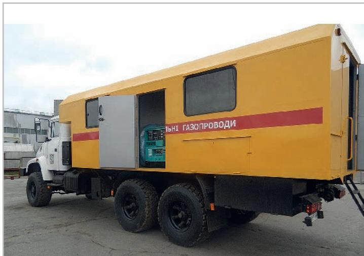
Сервисный автомобиль повышенной проходимости КРАЗ компании ПАО «Укртрансгаз» со сварочным агрегатом Denyo DCW-480ESW.
