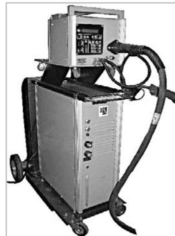
Рис. 2. Полуавтомат сварочный ПАРС Н-511
