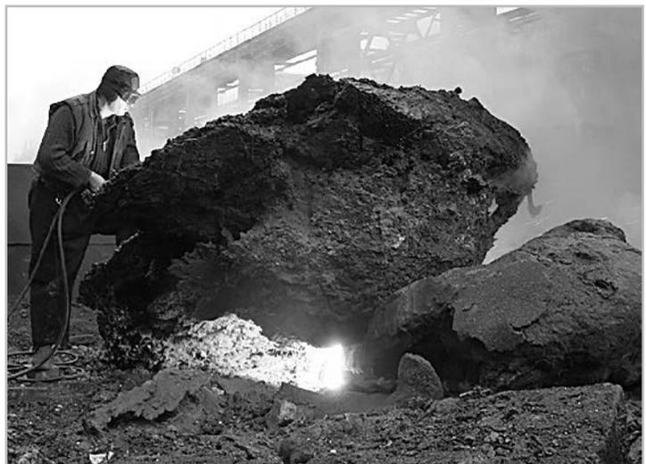
Рис. 9. Разделка крупной скрапины на габаритные куски газокислородным резаком РЗ-ФЛЦ-ВС
