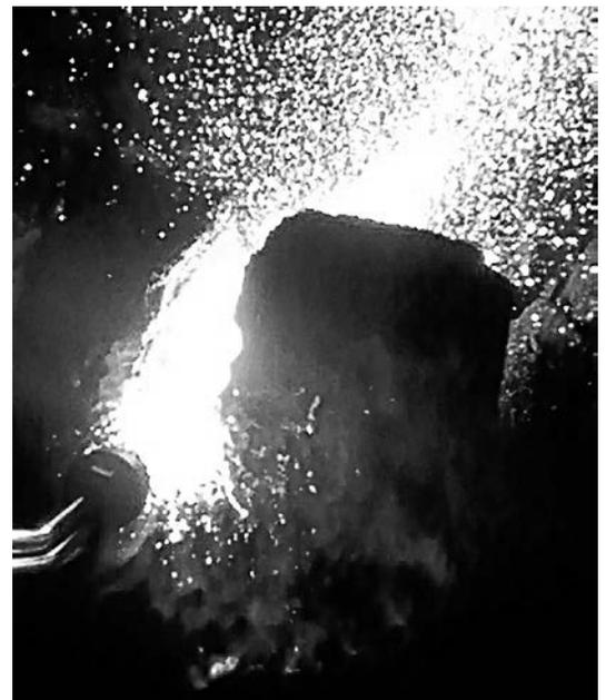
Рис. 5. Процесс кислородной резки резаком РЗ-ФЛЦ-ВС образца из высоколегированной стали 40Х9С2Л толщиной 350 мм
