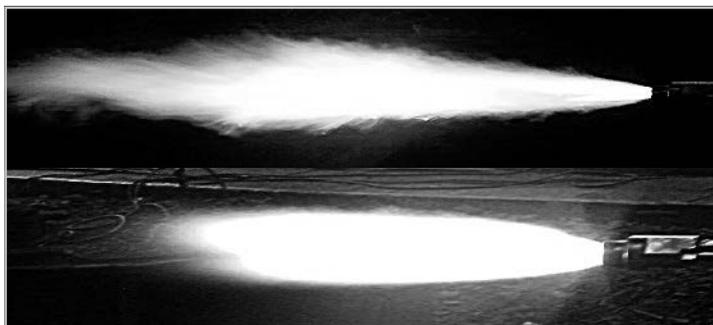
Рис. 4. Факела пламени газокислородного резака внешнего смешения РЗ-ФЛЦ-ВС: вверху — основной кислород выключен; внизу — включен
