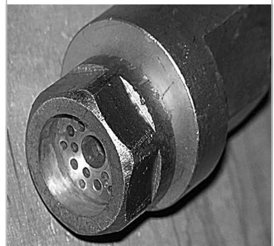
Рис. 2. Головка резака РЗ-ФЛЦ-ВС в сборе: вверху — схема; внизу — внешний вид
