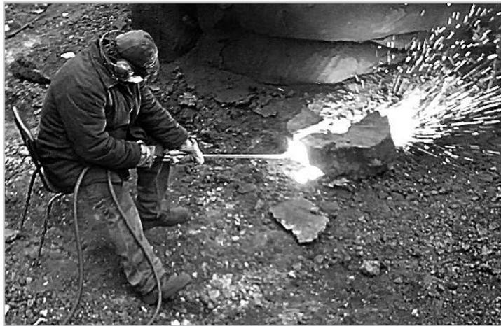
Рис. 6. Кислородная резка образца из стали 08X18H9Т толщиной 400 мм резаком РЗ-ФЛЦ-ВС с мундштуком № 3
