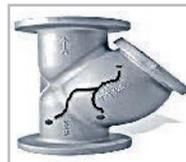
Рис. 1. Пример расположения отверстий при ремонте трещин
