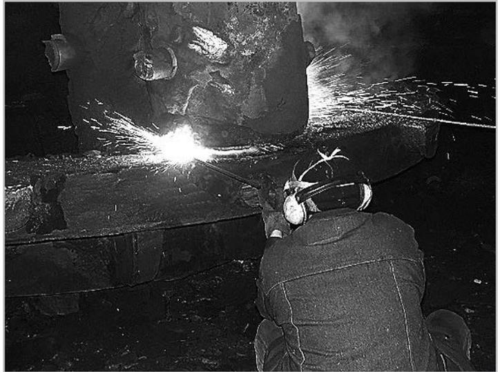
Рис. 8. Кислородная резка прибыли  $\varnothing 900$  мм литья из стали 20Л
