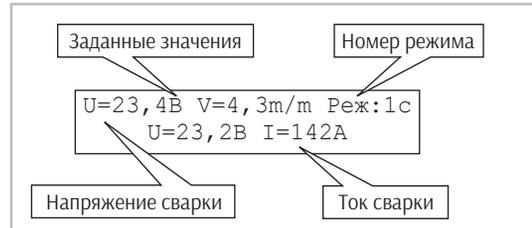
Рис. 5. Вид дисплея при сварке
