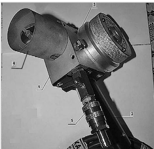
Рис. 3. Металлизатор ЭМ-01М: 1 – корпус, 2 – рукоятка, 3 – турбинный привод, 4 – распылительная головка, 5 – воздушный кран
