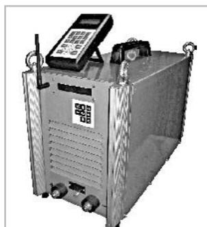
Рис. 1. Аппарат Ф-302 с устройством радиоуправления
