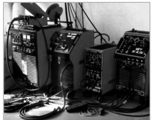
Рис. 7. Оборудование для дуговой сварки
