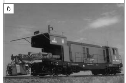
Рис. 3. Стационарные и мобильные рельсосварочные машины и комплексы на их основе: а – подвесная рельсосварочная машина K922-1; б – путевая рельсосварочная самоходная машина РСМ-3
