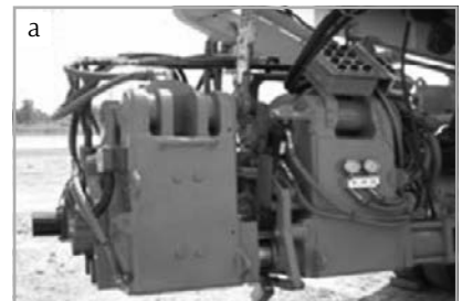
Рис. 3. Стационарные и мобильные рельсосварочные машины и комплексы на их основе: а – подвесная рельсосварочная машина K922-1; б – путевая рельсосварочная самоходная машина РСМ-3
