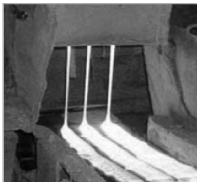
Рис. 6. Дуплекс-процесс производства современных сварочных флюсов
