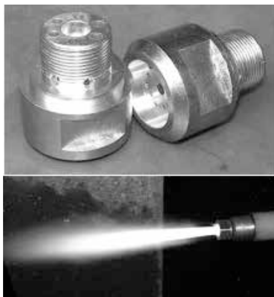
Рис. 3. Моноблочные мундштуки резака РГКМ-6С – вверху; видимая часть факела подогревающего пламени – внизу
