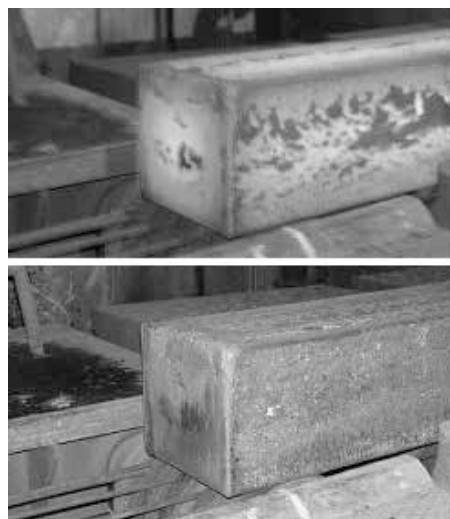
Рис. 8. Поверхность реза сечением 250х250 мм: на горячем слитке — вверху, на холодном слитке — внизу
