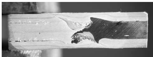
Рис. 3. Поперечное сечение соединения АМг5 – М1, полученного двусторонней сваркой
