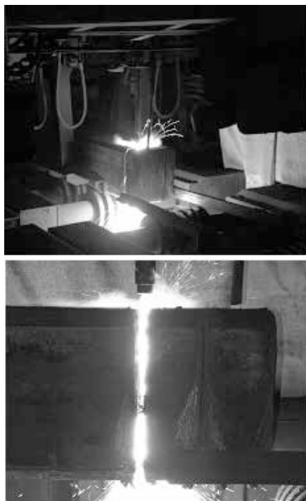
Рис. 4. Машина газовой резки горизонтального слитка вертикальным резаком в работе – вверху; полость реза при работающем резаке – внизу
