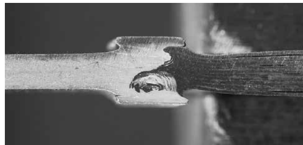
Рис. 5. Поперечное сечение сварного шва соединения АМг5 – пакет 10х0,3 мм М1
