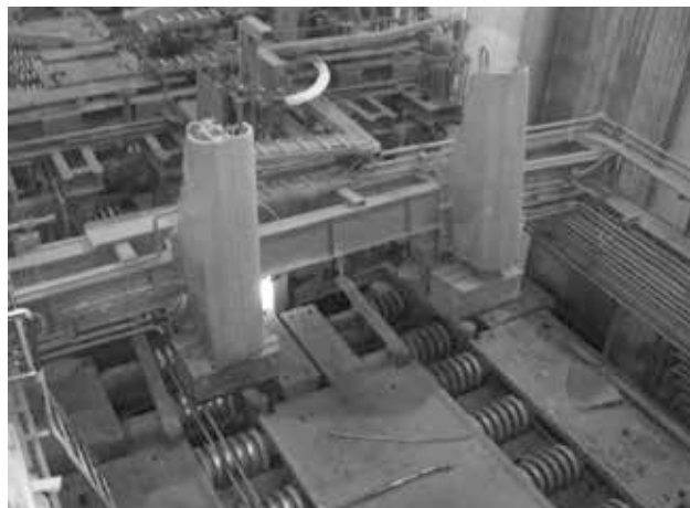
Рис. 5. Участок кислородной резки горизонтального слитка на мерные части (позиция 2 УНРС)
