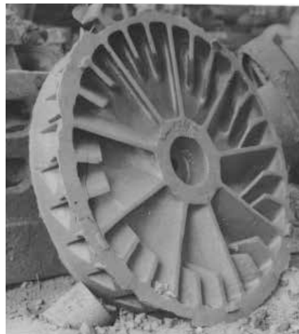
Рис. 5. Устранение недоливов в роторе насоса. Чугун ВЧ50
