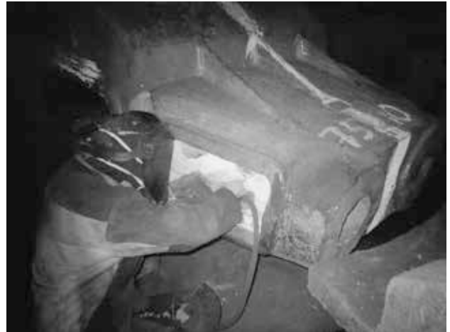
Рис. 3. Устранение дефектов внутри отливки корпуса бурового насоса. Материал – серый чугун
