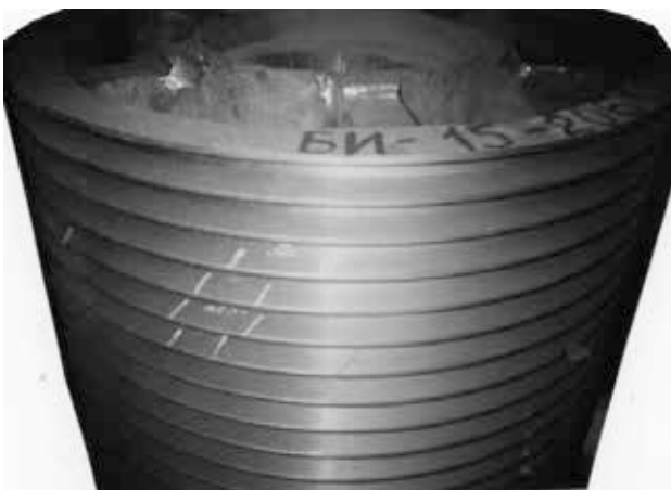
Рис. 7. Устранение литейных дефектов в ручьях высокооборотного шкива бурового насоса. Чугун СЧ25
