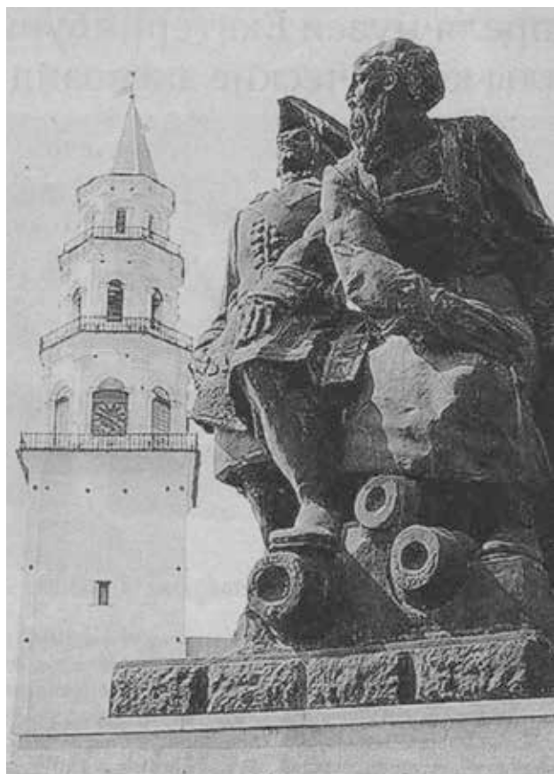
Рис. 4. Литосварной памятник «Петр Великий и Акинфий Демидов». Материал — серый чугун, длина сварных швов 130 м. Сварочные материалы — электроды из монель-металла. Толщина сваренного металла 20–40 мм (на заднем плане — легендарная «падающая» башня).
