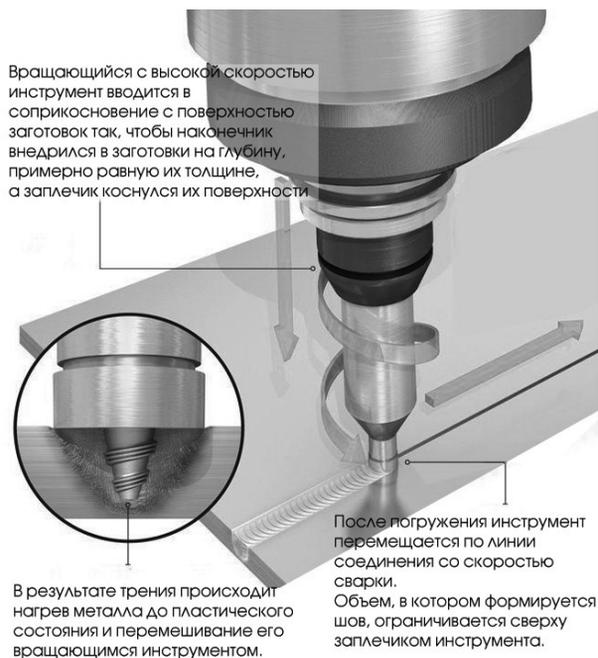
Рис. 1. Схема процесса СТП
