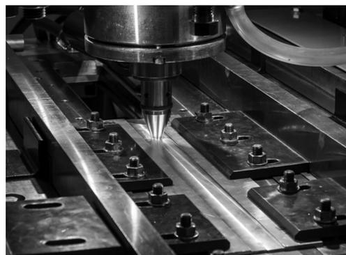
Рис. 8. Сварка стыкового шва
