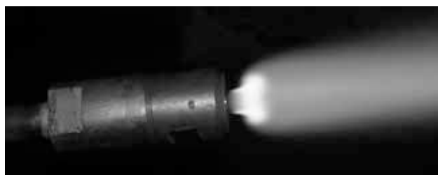
Рис. 10. Ядро факела газокислородной горелки для внепечного нагрева крупных заготовок с мундштуком в виде кольцевой щели
