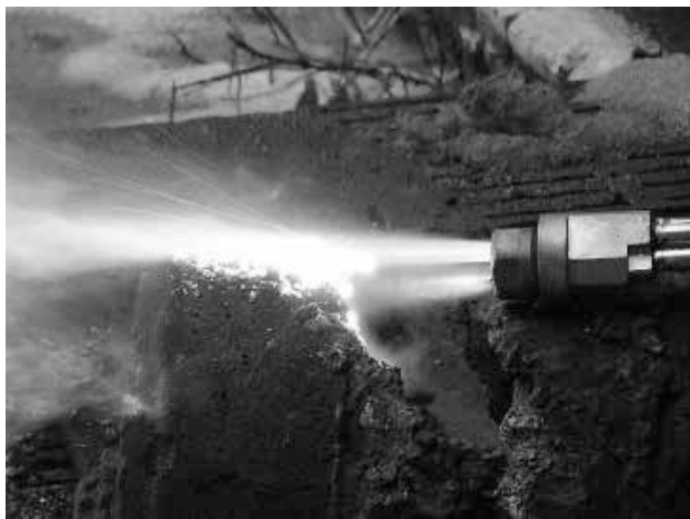
Рис. 3. Ядро факела с линейным источником тепла
