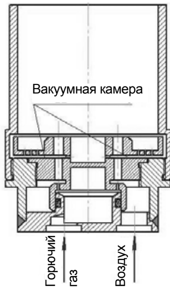
Рис. 11. Газовоздушная горелка с вакуумной камерой для увеличения разрежения на торце головки
