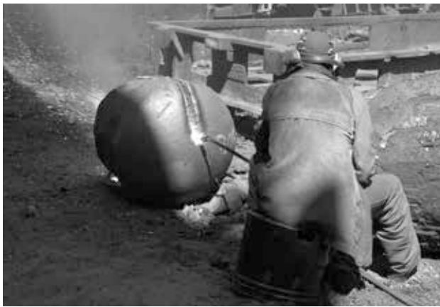
Рис. 7. Кислородная резка прибыльной части отливки на габаритные куски на ПАО «Энергомашспецсталь»
