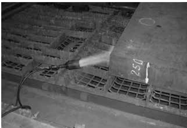
Рис. 12. Опытно-промышленное испытание горелки с вакуумной камерой для увеличения разрежения на торце головки в цехе металлоконструкций НКМЗ
