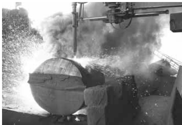
Рис. 9. Резка поковки Ø 1200 мм через усадочную раковину резаком РГКМ-5 на Уралмашзаводе
