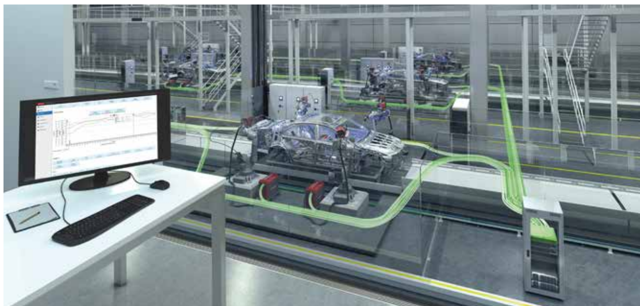
Рис 1. Weld Cube, система документирования и анализа данных от Fronius, позволяет непрерывно и точно отслеживать качество работы для 50 источников питания
