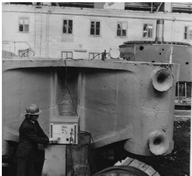
Рис. 3. НЧВО литого архитрава пресса усилием 5 тыс. тс
