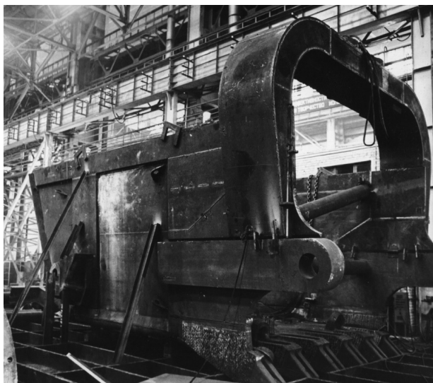
Рис. 4. Контрольная сборка ковша вместимостью 100 м 3 грунта шагающего экскаватора ЭШ-100.100
