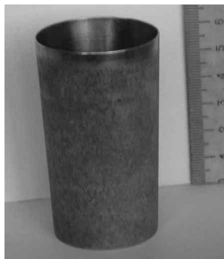
Рис. 1. Сувенир «Рюмка» емкостью 30 мл, изготовленный В.И. Дятловым из сварного шва корабельной броневой стали, протравленный А.А. Россошинским
