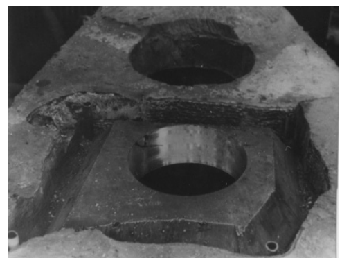
Рис. 2. Внешний вид вставки 1200x1100x230 мм (сталь 10ХСНД), приваренной в жесткий верхний настил отливки заготовки архитрава пресса усилием 5 тыс. тс
