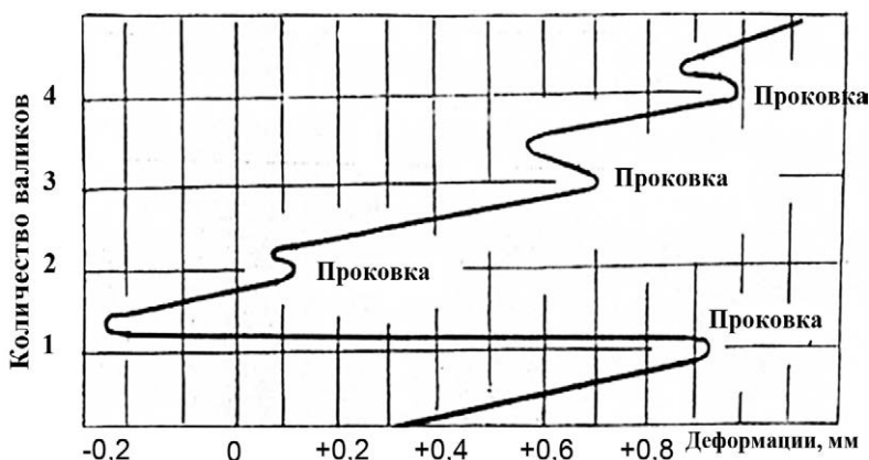
Рис. 1. Влияние проковки металла многослойного шва в процессе ремонтной сварки на временные деформации металла станины пресса усилием 100 МН
