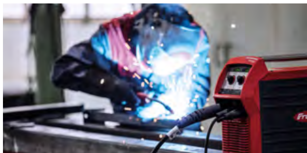
Рис 1. TransSteel 2200 - первый однофазный инверторный источник питания Fronius для сварки MIG / MAG. Отлично подходит для сварки стали в мастерских, во время выполнения строительных, ремонтных работ и технического обслуживания.
