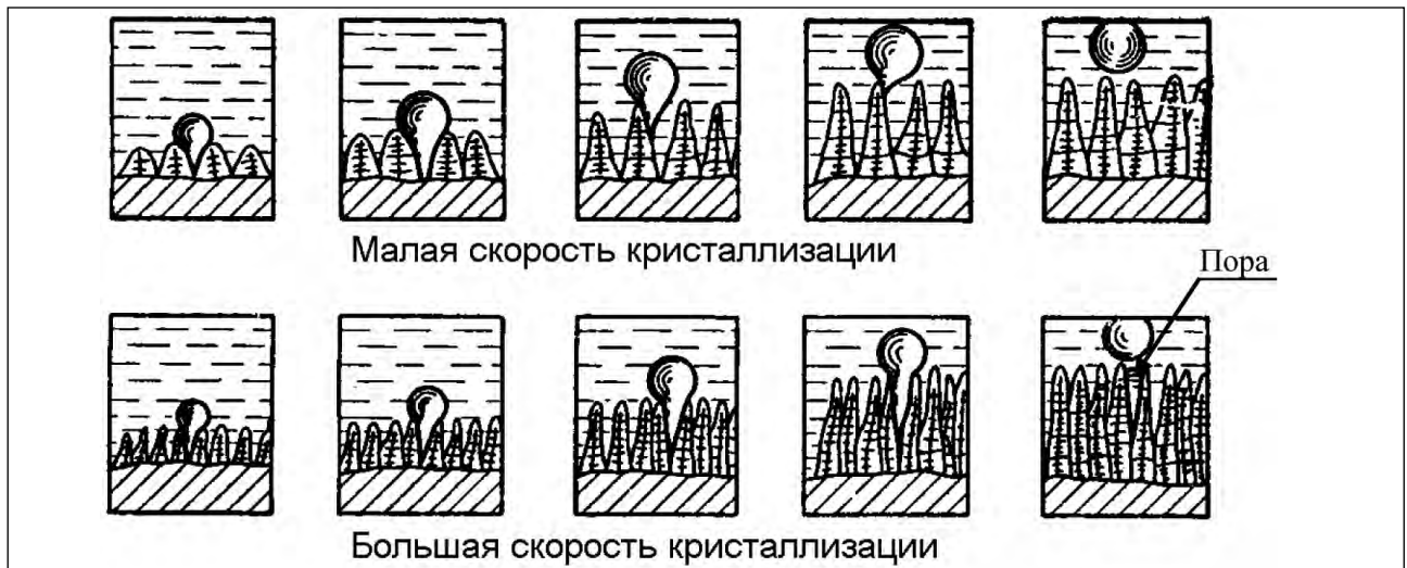
Рис. 7. Схема всплывания пузырьков газа при малой и большой скорости кристаллизации [9]
