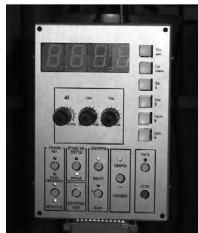
Рис. 2. Внешний вид источника питания ИЦ 616 УЗ.1, 617 УЗ.1 для сварки неплавящимся электродом в среде инертных газов (а), блока контроллера ИЦ 616.20.00.000 (б), пульта управления оператора выносного ИЦ 616.30.00.000 (в)
