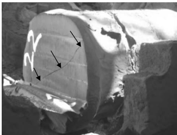
Рис. 11. Образование сквозной трещины в массивной поковке (сталь 38ХГН, диаметр 980 мм) при ее разделке машинной газокислородной резкой на скрап
