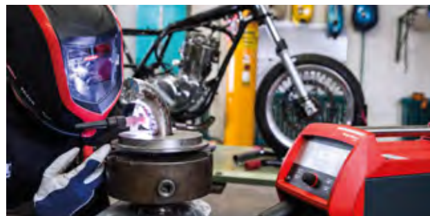
Рис 2. Источник питания MagicWave 230i может обмениваться данными с другими устройствами через интерфейсы Bluetooth, Wi-Fi и NFC.
