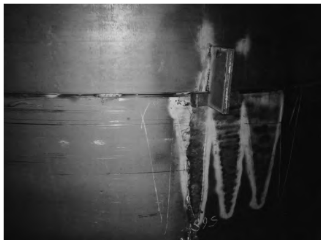
Рис. 5. Применение местного нагрева при сборке крупногабаритных конструкций под сварку
