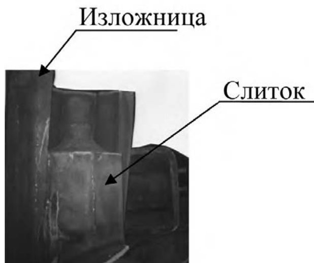
Рис. 2. Хрупкое разрушение изложницы в процессе кристаллизации слитка массой 100 т
