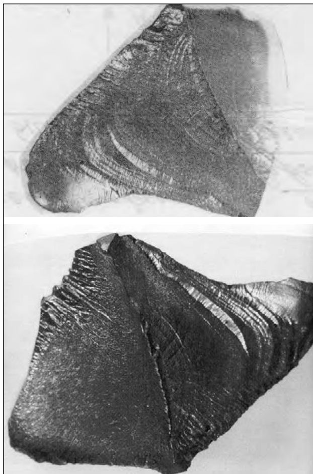
Рис. 10. Фрагмент детали, разрушенной в процессе предварительного подогрева. Состояние основного металла – закалка с отпуском
