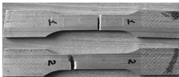
Рис. 7. Образцы 1* и 2*, изготовленные из основного металла после проведения испытаний на статическое растяжение
