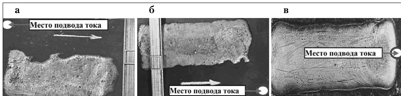
Рис. 7. Нарушение формы валика (521), наплавленного электрошлаковым методом двумя лентами шириной 120 мм, в зависимости от места подвода тока к изделию и влияния магнитного дутья: а – токоподвод с левой стороны от оси валика; б – токоподвод с правой стороны от оси валика; в – токоподвод по оси валика
