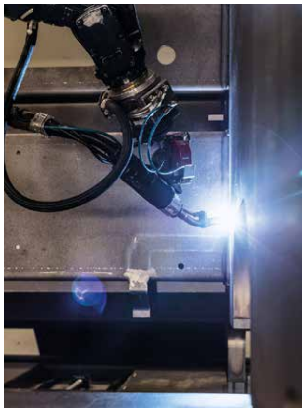
Рис. 1. Лазерно-гибридная сварка представляет собой сочетание двух различных сварочных процессов - лазерной сварки и сварки металлическим электродом в среде защитного газа (GMAW).
