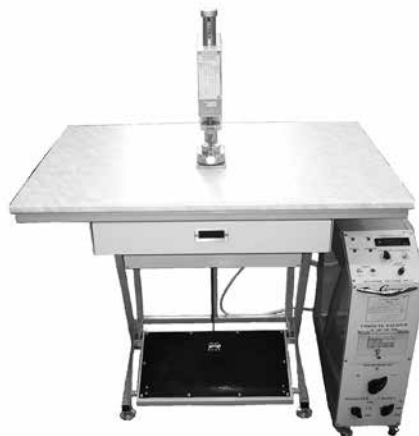
Рис. 2. Конденсаторная машина СМС-6 с источником ИП-1.2
