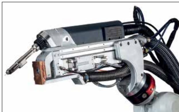
Рис. 2. Основным элементом сварочной системы является лазерно-гибридная головка с интегрированной сварочной горелкой MIG/MAG и лазерной оптикой.
