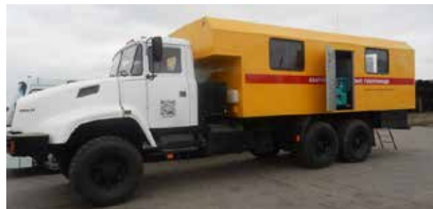
Сервисный автомобиль компании ПАО «Укртрансгаз» со сварочным агрегатом Denyo DCW-480ESW
