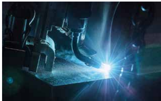
Рис. 3. Лазерный луч разогревает поверхность детали и обеспечивает глубокое проплавление в узкой зоне. Затем электрическая дуга формирует широкую сварочную ванну, обеспечивая отличное перекрытие зазоров.
