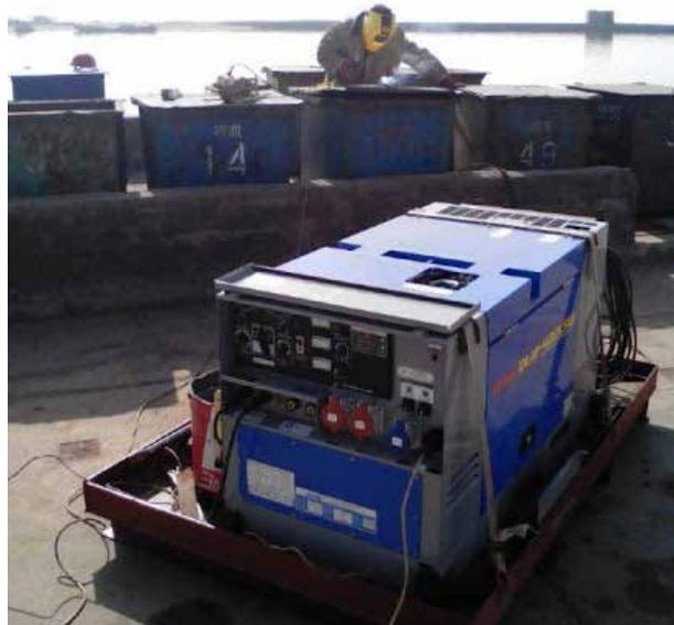
Рис. 4. Использование сварочного агрегата DENYO DLW-400LSW при портовых ремонтных работах в Мариупольском морском торговом порту
