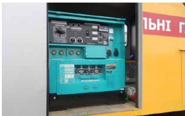
Рис. 2. Применение DENYO DCW-480ESW в аварийных машинах
