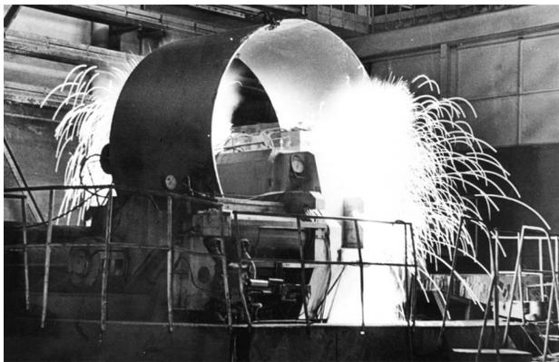
Рис. 6. «ЮМЗ», контактная сварка обечайки
