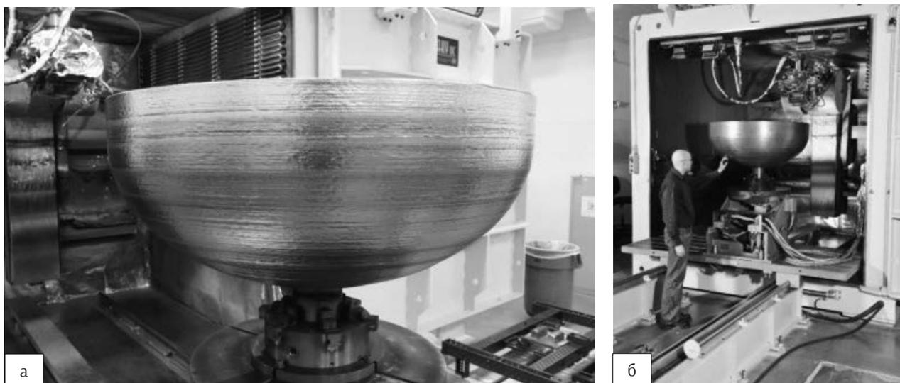
Рис. 1. Бак ракетного топлива (а) и электронно-лучевая камера для 3D-печати (б)
