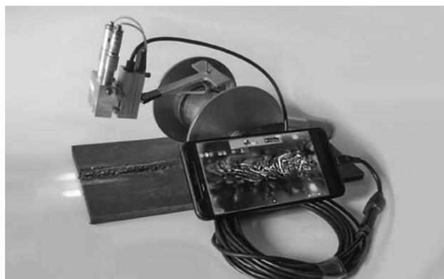
Рис. 1. Внешний вид предложенного устройства визуального контроля с двумя лазерными указателями, с подсветкой околошовной зоны и USB Веб-камерой
