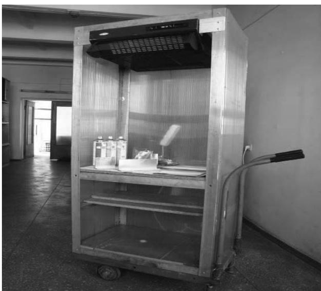
Рис. 11. Стенд капиллярного контроля
