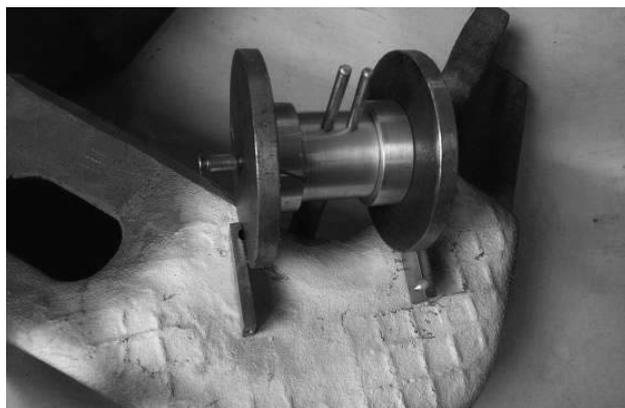
Рис. 9. Подвижные намагничивающие устройства
