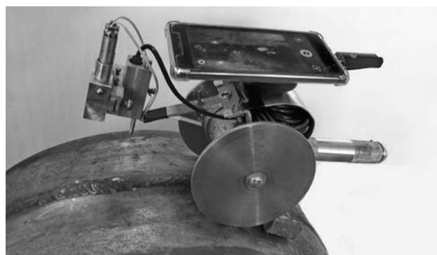
Рис. 4. Разработанное устройство в процессе записи на сварном шве обечайки Ø 1020 мм газовой трубы. Фиксируются неравномерности сварного шва, подрезы и поры, выходящие на поверхность
