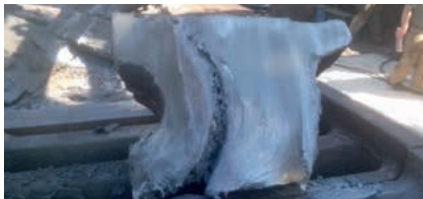
Рис. 20. Кислородная резка заготовки сложной формы толщиной 1200 мм с усадочной раковинной на машине УОПП-1. Поверхность реза
