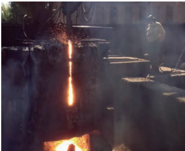
Рис. 10. Кислородная резка заготовки прямоугольного сечения толщиной 1850 мм
