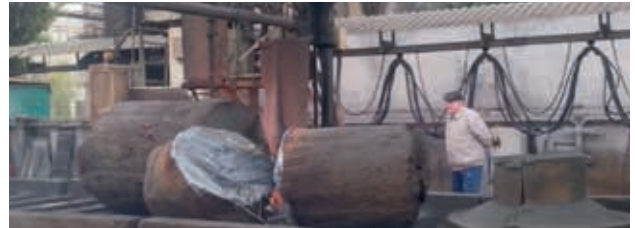
Рис. 25. Кислородная резка конца поковки круглого сечения диаметром 1400 мм с усадочной раковиной в центре. Поверхность реза
