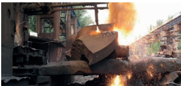
Рис. 17. Разделка осколка чугунного диска на габаритные куски
