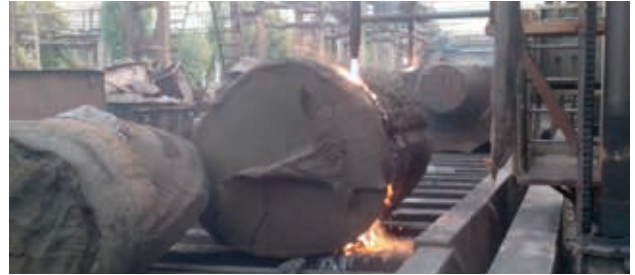
Рис. 24. Кислородная резка конца поковки круглого сечения диаметром 1400 мм с усадочной раковиной в центре. Процесс резки
