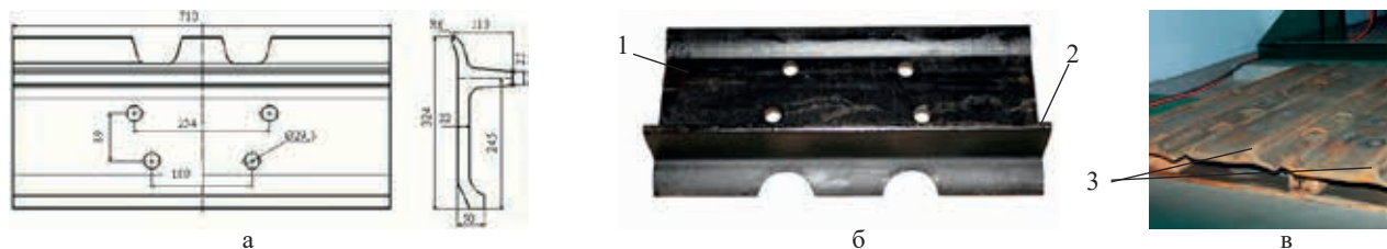
Рис. 1. Конструкция (а), внешний вид нового (б) и изношенных башмаков гусеничного полотна трактора Komatsu (в): 1 – корпус башмака; 2 – грунтозацеп; 3 – изношенные грунтозацепы
