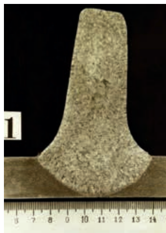
Рис. 5. Поперечный (а) и продольный (б) макрошлифы опытных образцов наплавленных грунтозацепов
