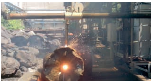
Рис. 18. Кислородная резка поковки толщиной 1200 мм с усадочной раковинной на машине УОПП-1
