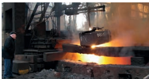
Рис. 16. Кислородная резка конца поковки диаметром 1300 мм и толщиной 750 мм из высоколегированной стали 08X18H10T. Процесс кислородной резки
