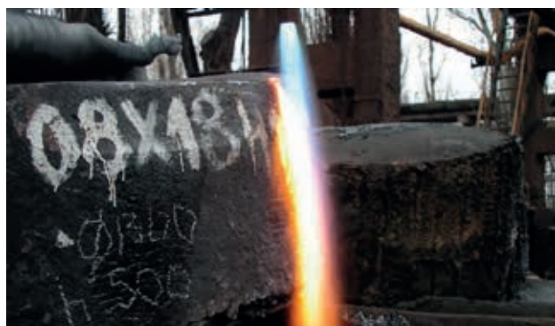
Рис. 15. Кислородная резка конца поковки диаметром 1300 мм и толщиной 750 мм из высоколегированной стали 08X18H10T. Факел резака РГКМ-2000, прогрев заготовки перед врезанием
