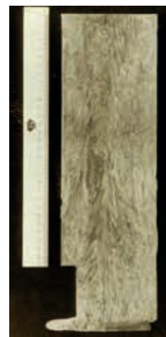
Рис. 5. Поперечный (а) и продольный (б) макрошлифы опытных образцов наплавленных грунтозацепов
