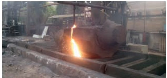
Рис. 26. Кислородная резка фрагмента крупного слитка толщиной 1300 мм.
