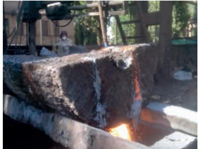
Рис. 12. Разделка крупного отхода с остатками формовочной смеси толщиной 1300 мм на габаритные куски
