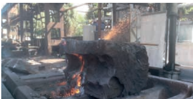
Рис. 19. Кислородная резка заготовки сложной формы толщиной 1200 мм с усадочной раковинной на машине УОПП-1. Процесс резки
