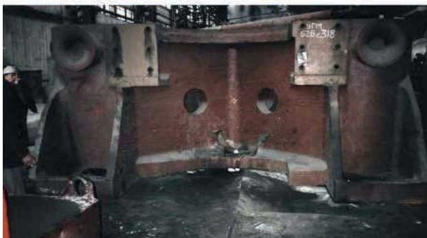
Станина пресса 10000 тс (масса 108 т, сталь 35Л), место ремонта Нижнеднепровский трубный завод, г. Днепр. Характерные повреждения станины пресса 10000 тс
