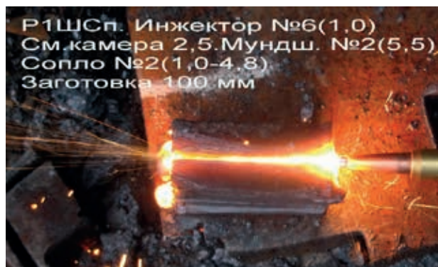
Рис. 15. Процесс резки образца толщиной 100 мм резаком Р1Ш-Сп
