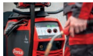
Мал. 3. Імпульсне зварювання допомагає отримати охайний хвилястий шов та мінімізувати деформацію матеріалу під час прихоплювання
