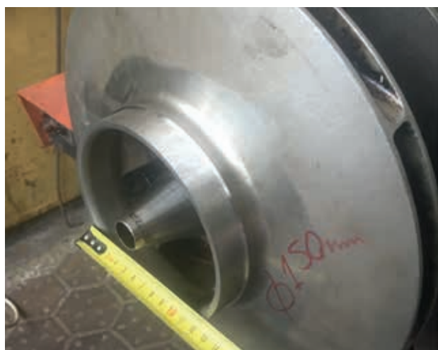
Рис. 2. Наплавка нержавеющей стали: а) до наплавки, б) после наплавки
