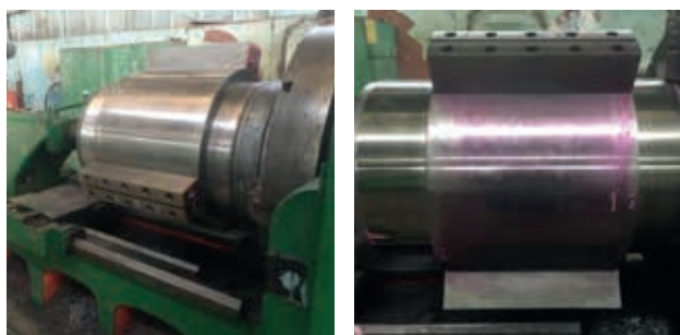
Рис. 3. Обработка на токарном станке. После ремонта. Март 2019 г.
