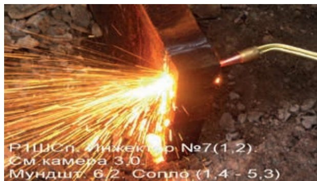
Рис. 13. Испытание резака Р1Ш-Сп на режущие свойства. Толщина заготовки – 80 мм. Материал – Сталь 20. Процесс резки
