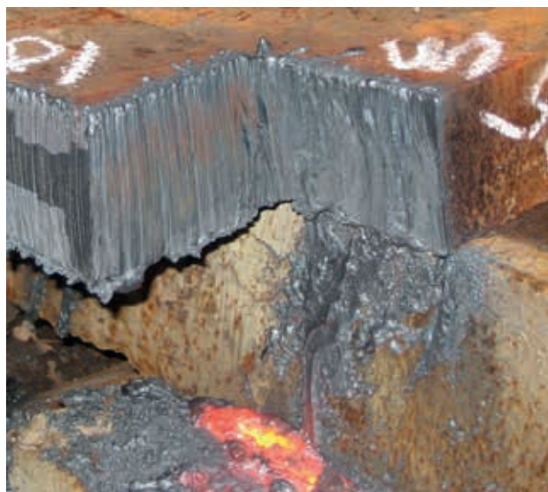
Рис. 14. Испытание резака Р1Ш-Сп на режущие свойства. Толщина заготовки – 80 мм. Материал – Сталь 20. Поверхность реза
