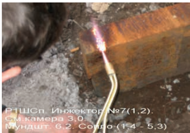
Рис. 12. Испытание резака Р1Ш-Сп на режущие свойства. Толщина заготовки – 80 мм. Материал – Сталь 20. Врезание
