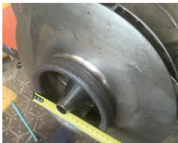
Рис. 2. Наплавка нержавеющей стали: а) до наплавки, б) после наплавки
