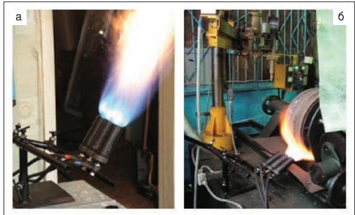
Рис. 7. Одновременная работа трех горелок ГВ-Ф (а) и использование двух горелок при нагреве барабана
