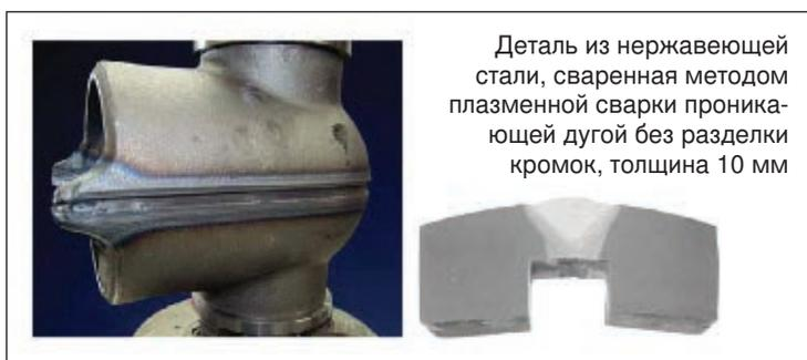
Деталь из нержавеющей стали, сваренная методом плазменной сварки проникающей дугой без разделки кромок, толщина 10 мм
