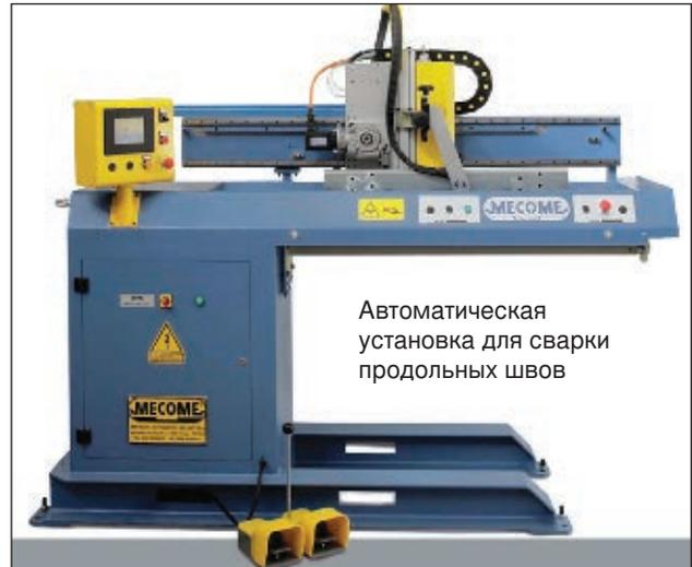
Автоматическая установка для сварки продольных швов
