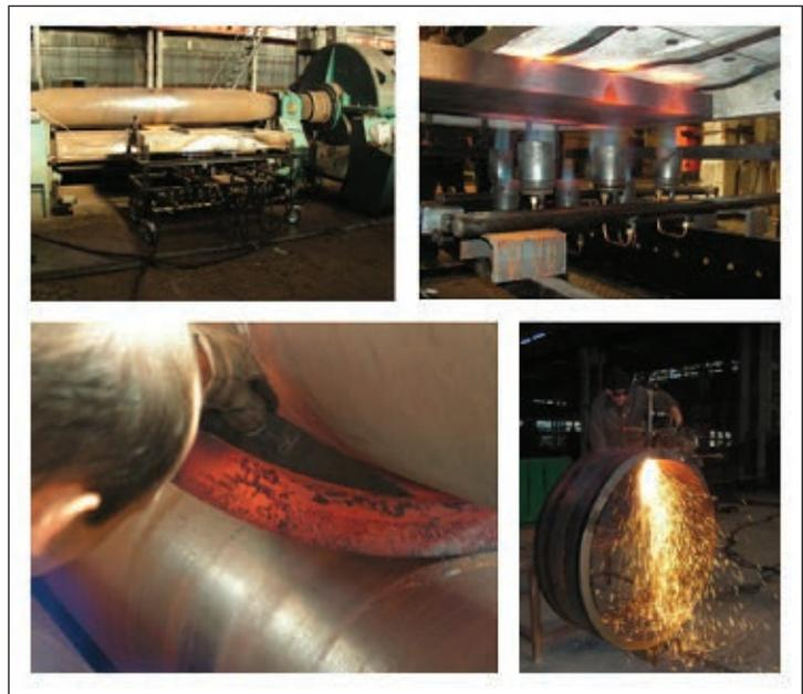
Работа установки на заводе показала ее эффективность. Конец листа сечением 70×700 мм прогревается на глубину 600 мм до температуры 650°C за 32 мин при использовании трех коллекторов с тремя горелками ГВ-ВК7 на каждом. Общий расход природного газа в расчете на один нагрев составил 28 м<sup>3</sup>. При отсутствии на заводе печного оборудования необходимой мощности без данной установки процесс нагрева концов листа для подвальцовки невозможен.
