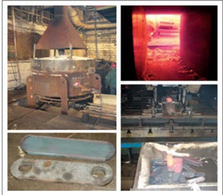
Рис. 1. Нагрев и штамповка звеньев цепи из листовых заготовок толщиной 16 мм
