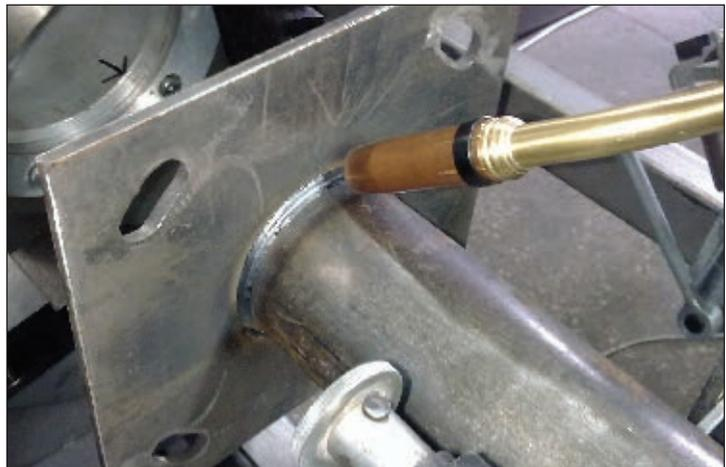
Рис. 2. Кольцевой шов соединения трубы с фланцем
