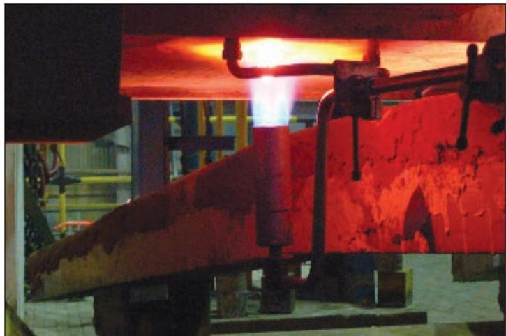
Рис. 3. Работа устройства для разогрева стаканов-дозаторов
