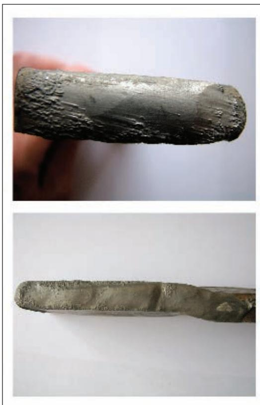
Рис. 3. Рабочие кромки лопатки, наплавленные материалом Technodur GN
