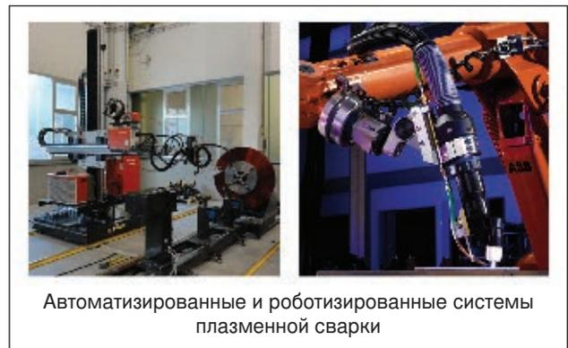
Автоматизированные и роботизированные системы плазменной сварки
