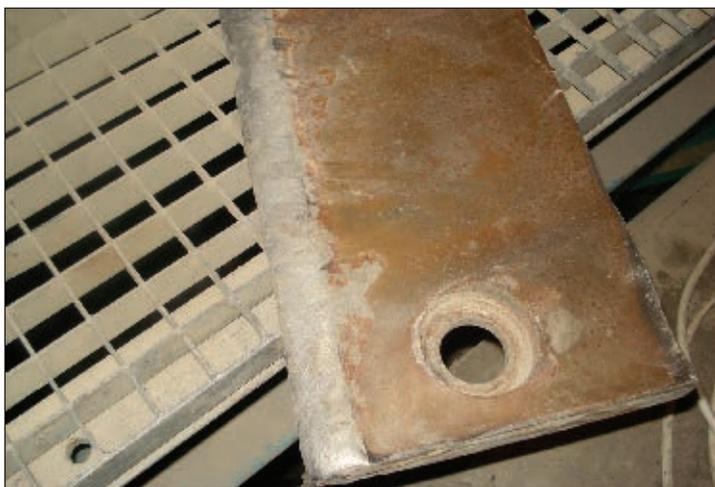
Рис. 4. Быстроизнашивающийся лист с наплавкой рабочей кромки, выведенный из эксплуатации после чрезмерного износа основной поверхности
