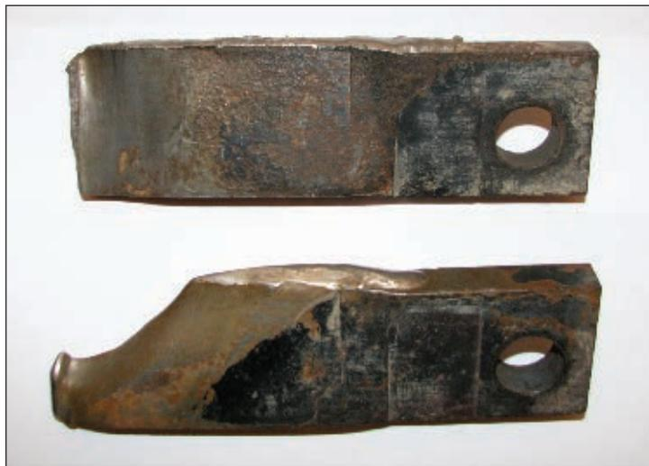
Рис. 2. Степень износа лопаток смесителя: вверху — лопатка, наплавленная Technodur GN через 3 месяца эксплуатации; внизу — лопатка, наплавленная электродом Т-620, через 1 неделю эксплуатации
