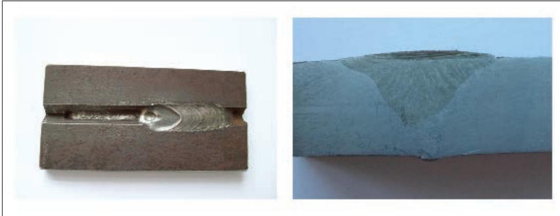
Рис. 2. Внешний вид и макрошлиф стыкового шва
