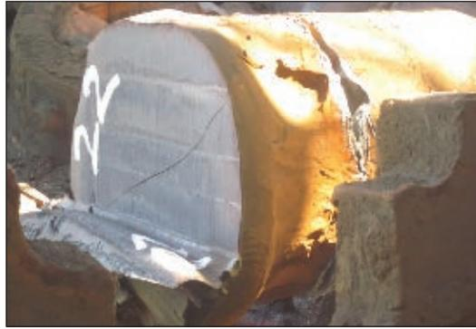
Рис. 2. Рабочий момент машинной газовой резки толстолистовой поковки (диаметр 980 мм). Сталь 38ХГН
