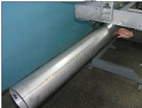
Рис. 2. Внешний вид сварного шва
