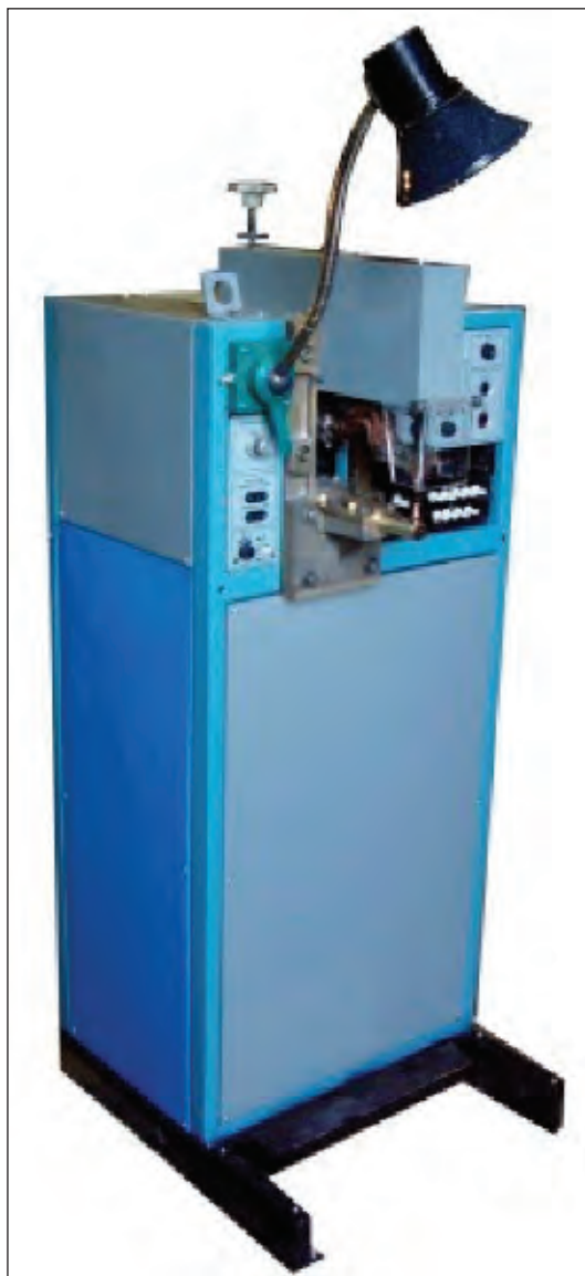
Рис. 3. Точечная конденсатор- ная машина МТК-2201 (ТКМ-17) универ- сального назначения
