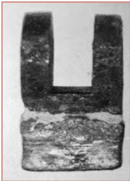
Рис. 3. Било после наплавки сормайтом (вверху наплавленный слой)
