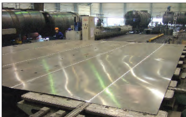
Рис. 5. Карта, полученная сваркой трением с перемещением из проката 7000x1500 мм
