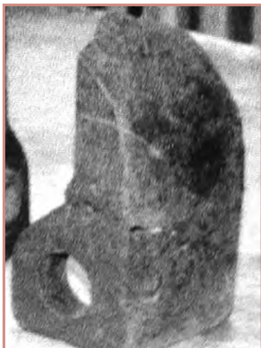
Рис. 1. Общий вид изношенной П-образной билы
