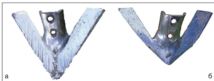
Рис. 7. Лапа культиватора с лазерной закалкой (а) и без закалки (б)
