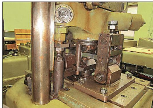
Рис. 6. Наплавленный образец во время проведения усталостных испытаний
