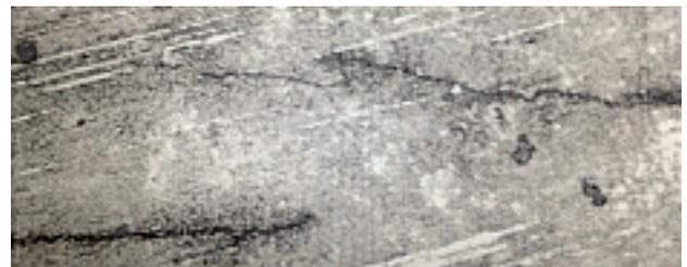
Рис 4. Вид трещин в ЗТВ, x500
