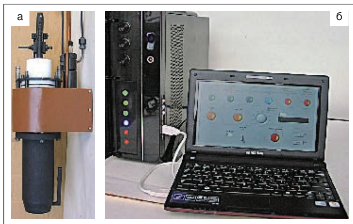
Рис. 1. Часть оборудования для импульсно-плазменной обработки: а — генератор импульсной плазмы; б — автоматизированный пульт управления
