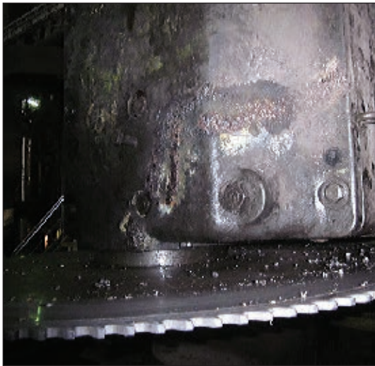
Рис. 10. Восстановленная крышка разрушенной пилы
