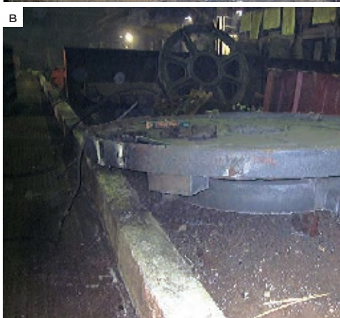
Рис. 7. Сварка кольца: а, б — фрагменты приваренных элементов; в — вос- становленная заготовка кольца
