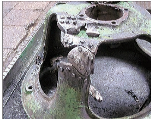
Рис. 11. Кожух электродвигателя строгательного станка, подготовленный к восстановительным работам
