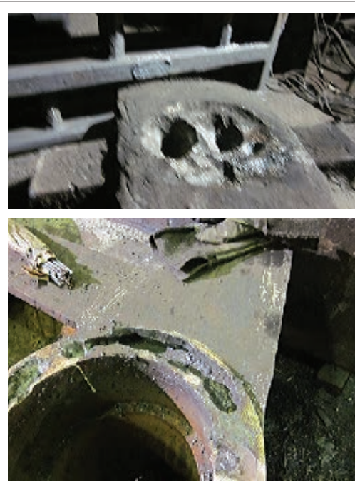
Рис. 3. Полугорячая сварка чугунных изложниц: а — положение изложницы при предварительном и сопутствующем подогреве в процессе ремонтной сварки; б — разбивка протяженной разделки на отдельные участки; в — вид наплавленного металла
