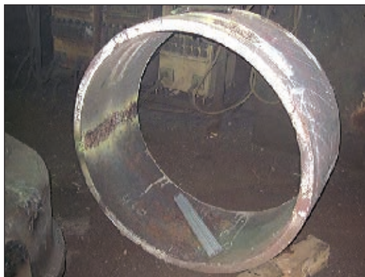
Рис. 6. Устраненная сквозная трещина
