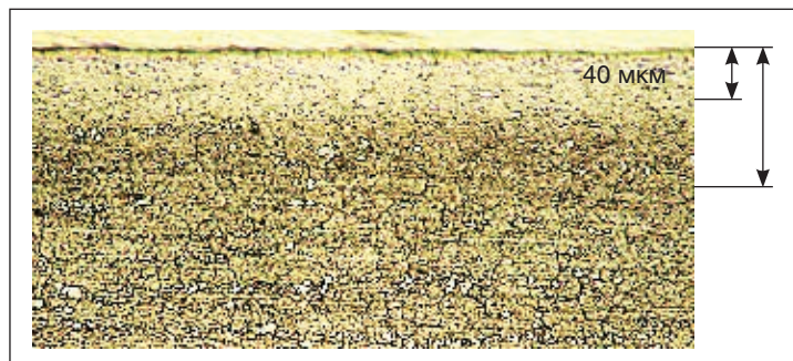
Рис. 3. Структура поверхностного слоя стали Р6М5 после импульсно-плазменной обработки, \times 500
