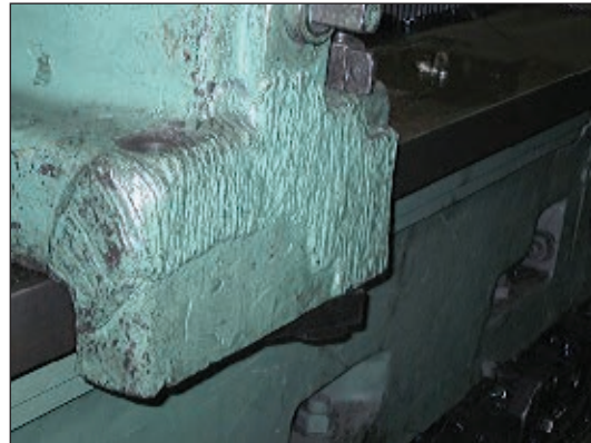
Рис. 9. Восстановленный люнет уникального токарного станка (сварочный материал Э50А)
