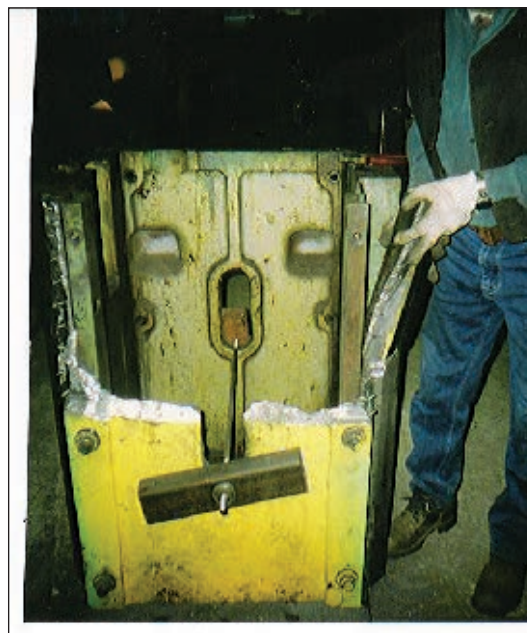
Рис. 1. Разборка сломанных частей пресса
