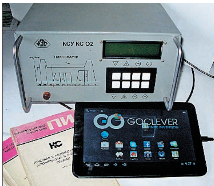
Рисунок. КСУ КС и планшетный компьютер с программой электронного справочника
