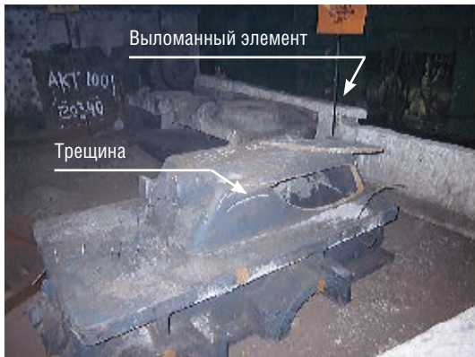
Рис. 8. Внешний вид изломанной крышки редуктора
