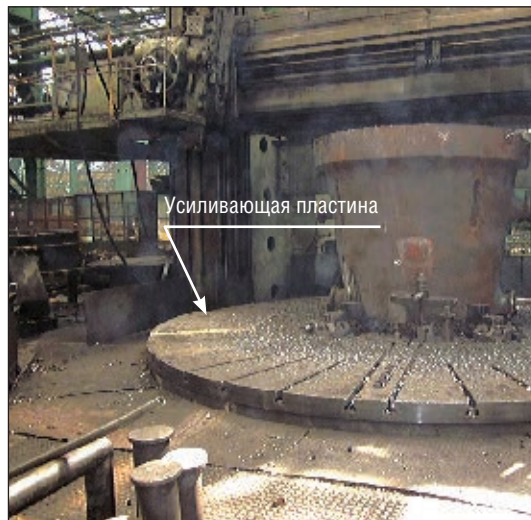
Рис. 12. Вид восстановленной планшайбы карусельного станка
