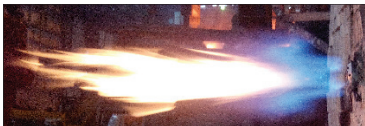
Рис. 5. Работа модернизированной горелки ГНД-100 М
