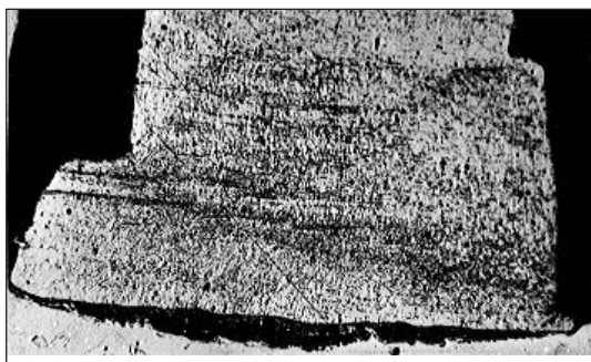
Рис. 6. Копровый цех. Резка слитка диаметром 1500 мм установкой УОПП-1 (2013 г.)
