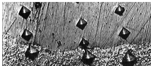
Рис. 6. Соединение медной проволоки с проволочным алюминиевым электродом после термических испытаний (микрошлиф не травлен) \times 500
