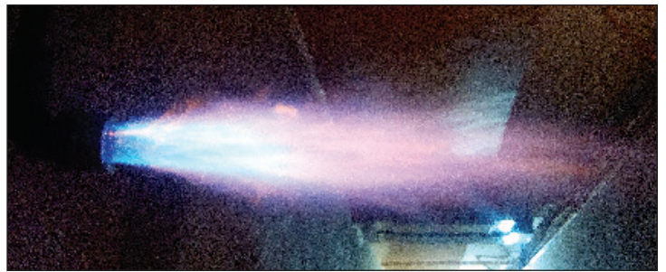
Рис. 2. Испытание горелки ГН 53/3,9 М на открытом пространстве
