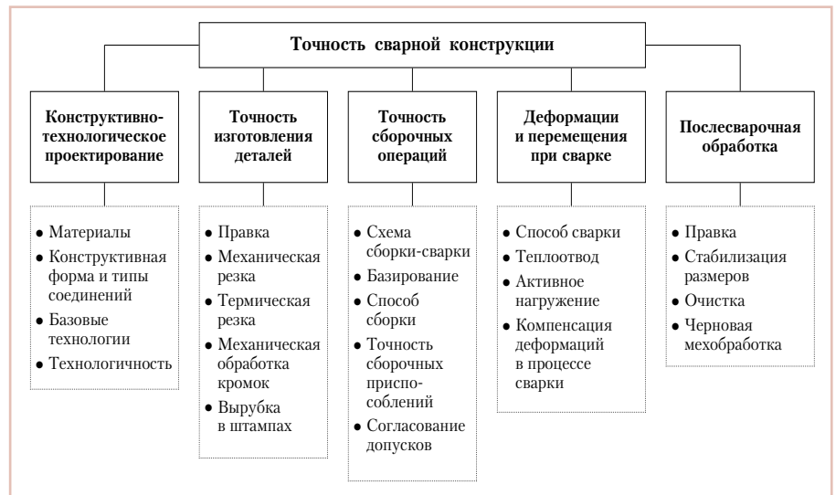
Рис. 26. Схема влияния различных факторов при проектировании и изготовлении на точность сварных конструкций
