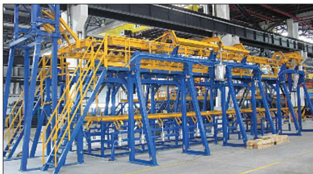
Рис. 10. Универсальный стенд сборки изотермического кузова
