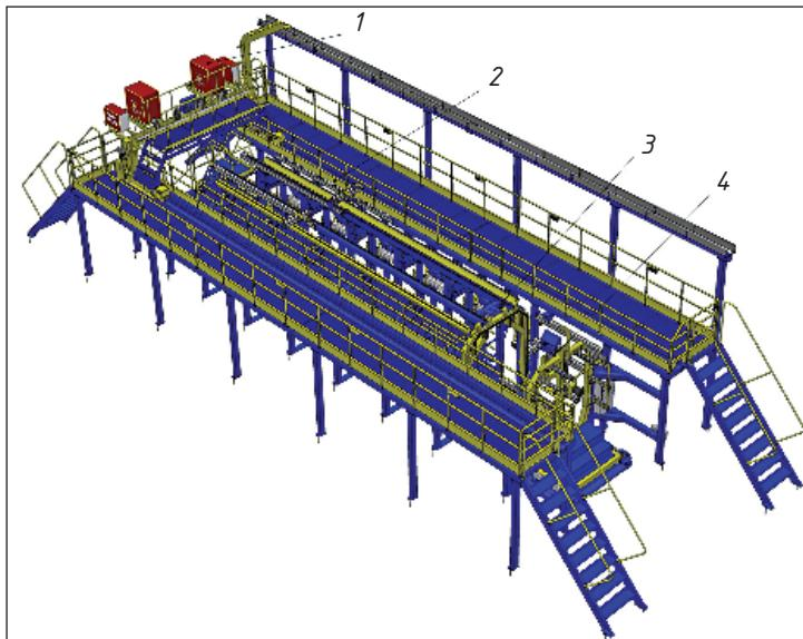
Рис. 5. Универсальный переналаживаемый стенд сборки кузова само-свала
