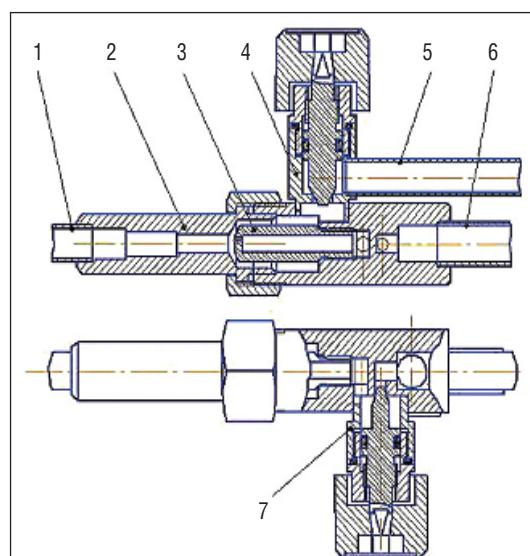
Рис. 4. Узел смешивания рабочих газов в горелках ГЗУ-03, ГЗУ-04 и ГЗУ-04-НД
