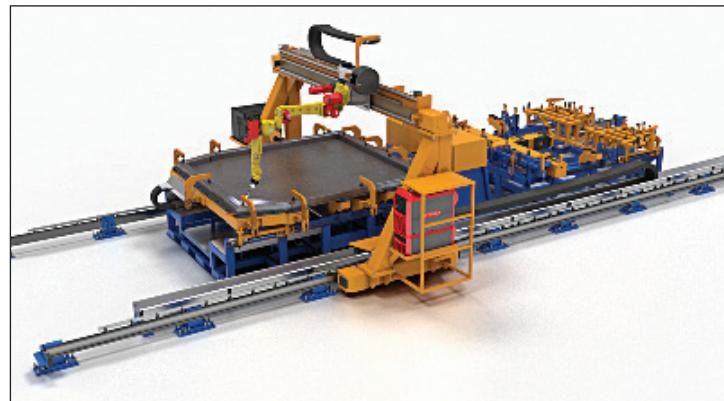
Рис. 9. Роботизированный комплекс сборки и сварки задних дверей самосвала
