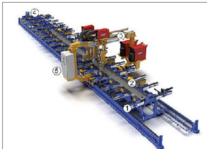
Рис. 2. Общий вид линии сборки и сварки лонжеронов: 1 – стенд для сборки лонжеронов; 2 – кантователь; 3 – сварочный портал; 4 – гидростанция; 5 – шкаф управления
