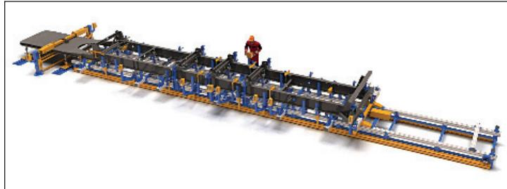
Рис. 4. Сборка рамы изотермического полуприцепа
