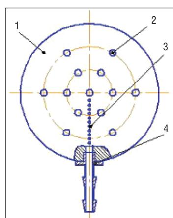
Рис. 1. Мундштук горелки для замеров разрежения на торце
