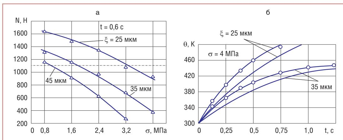
Рис. 14. Зависимость среднего значения разрывной нагрузки  $N$  сварных соединений при сдвиге от сварочного давления  $\sigma$  при различных амплитудах колебаний волновода  $x$  (а) и термические циклы при УЗС искусственных кож (б)
