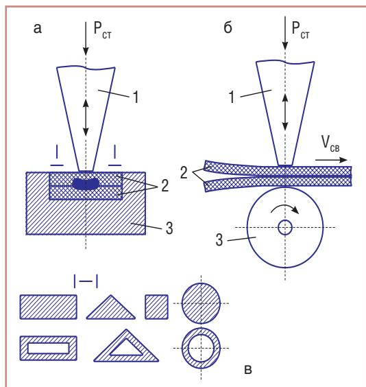
Рис. 12. Схема контактной ультразвуковой сварки: а – прессовая; б – шовная; в – возможные формы рабочего торца волновода-инструмента (1 – волновод-инструмент; 2 – свариваемые детали; 3 – опора)
