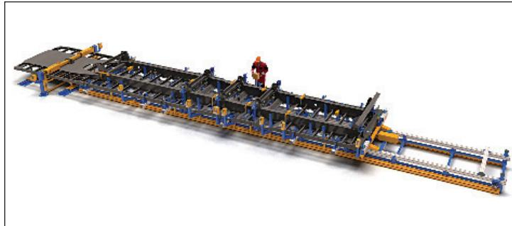
Рис. 3. Сборка рамы тентового полуприцепа
