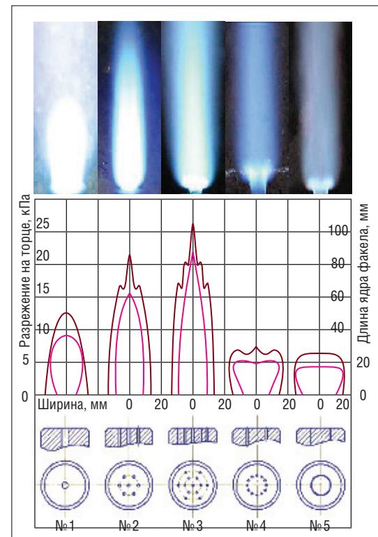
Рис. 2. Величина разрежения на торце мундштука (коричневые кривые на графике); величина и форма ядра пламени (красные кривые на графике и фото), № 1 – однослойный мундштук; № 2 – многослойный однорядный мундштук с отверстием в центре; № 3 – многослойный двухрядный мундштук с отверстием в центре; № 4 – многослойный однорядный мундштук; № 5 – мундштук с кольцевой щелью на выходе
