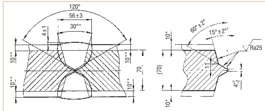
Рис. 1. Разделка кромок под сварку
