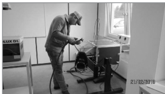
Рис. 2. Виртуальная система VWTS
