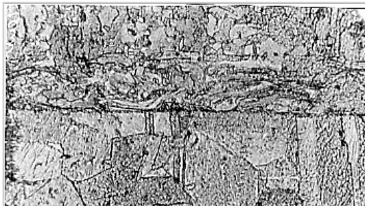
Рис. 3. Микроструктура соединения стальной проволоки \varnothing 0,8 мм (сверху) с медной пластиной, \times 600
