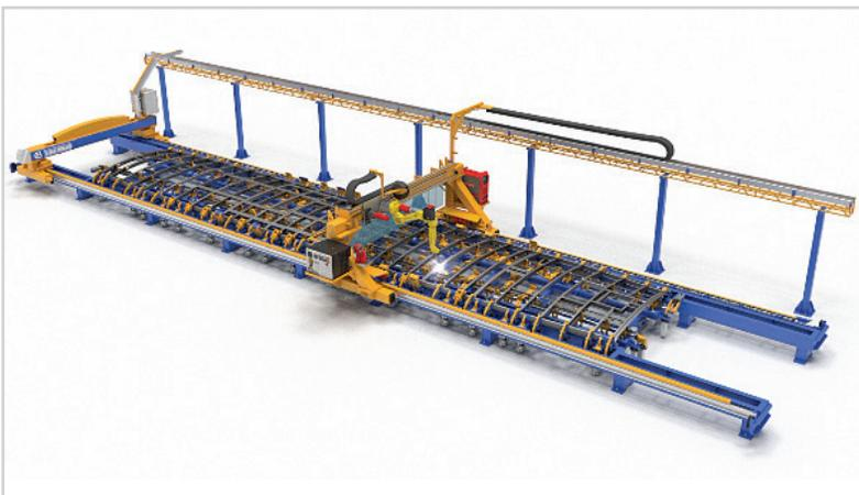
Рис. 1. Общий вид универсального станда сборки и роботизированной сварки крыш.
