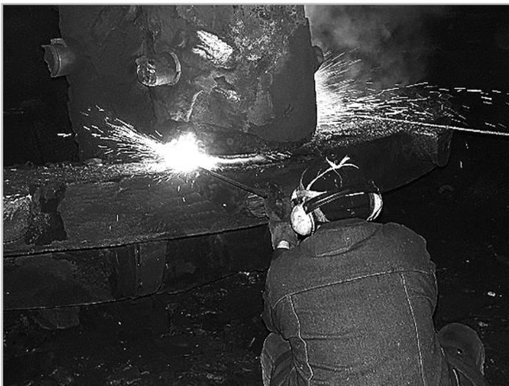
Рис. 7. Кислородная резка прибыли Ø900 мм литья из стали 20Л
