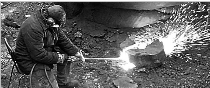
Рис. 5. Кислородная резка образца из стали 08X18H9Т толщиной 400 мм резаком РЗ-ФЛЦ-ВС с мундштуком № 3
