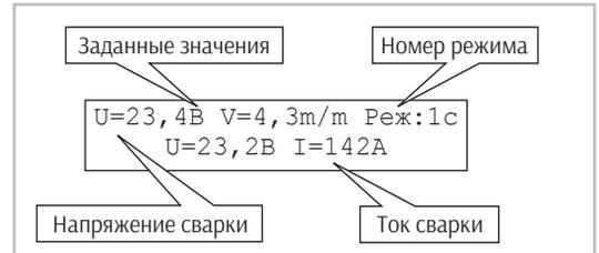
Рис. 5. Вид дисплея при сварке
