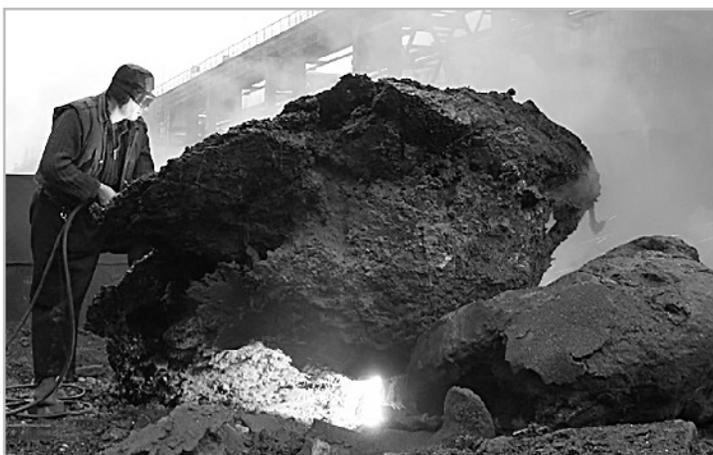
Рис. 8. Разделка крупной скрапины на габаритные куски газокислородным резаком РЗ-ФЛЦ-ВС
