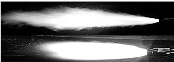
Рис. 4. Факела пламени газокислородного резака внешнего смешения РЗ-ФЛЦ-ВС: вверху — основной кислород выключен; внизу — включен
