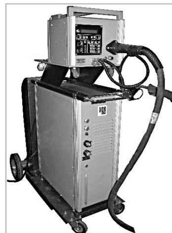
Рис. 2. Полуавтомат сварочный ПАРС Н-511
