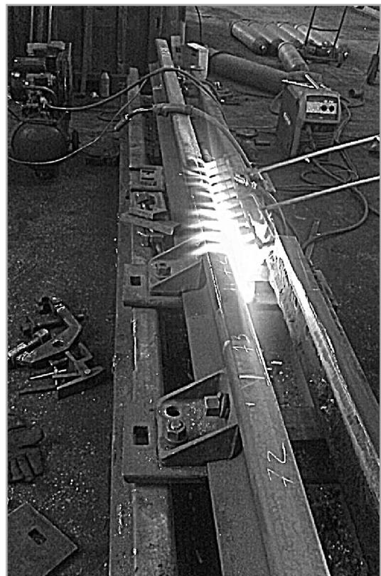
Рис. 4. Процесс нагрева участка рельса под наплавку горелкой ГЗУ6-ЖД
